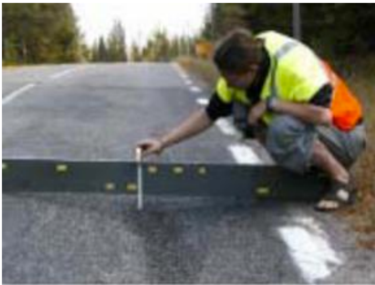
Kuva 10. Oikolaudalla urasyvyyden mittaamista vanhasta pinnasta. (Tiehallinto, 2007) [22.]
