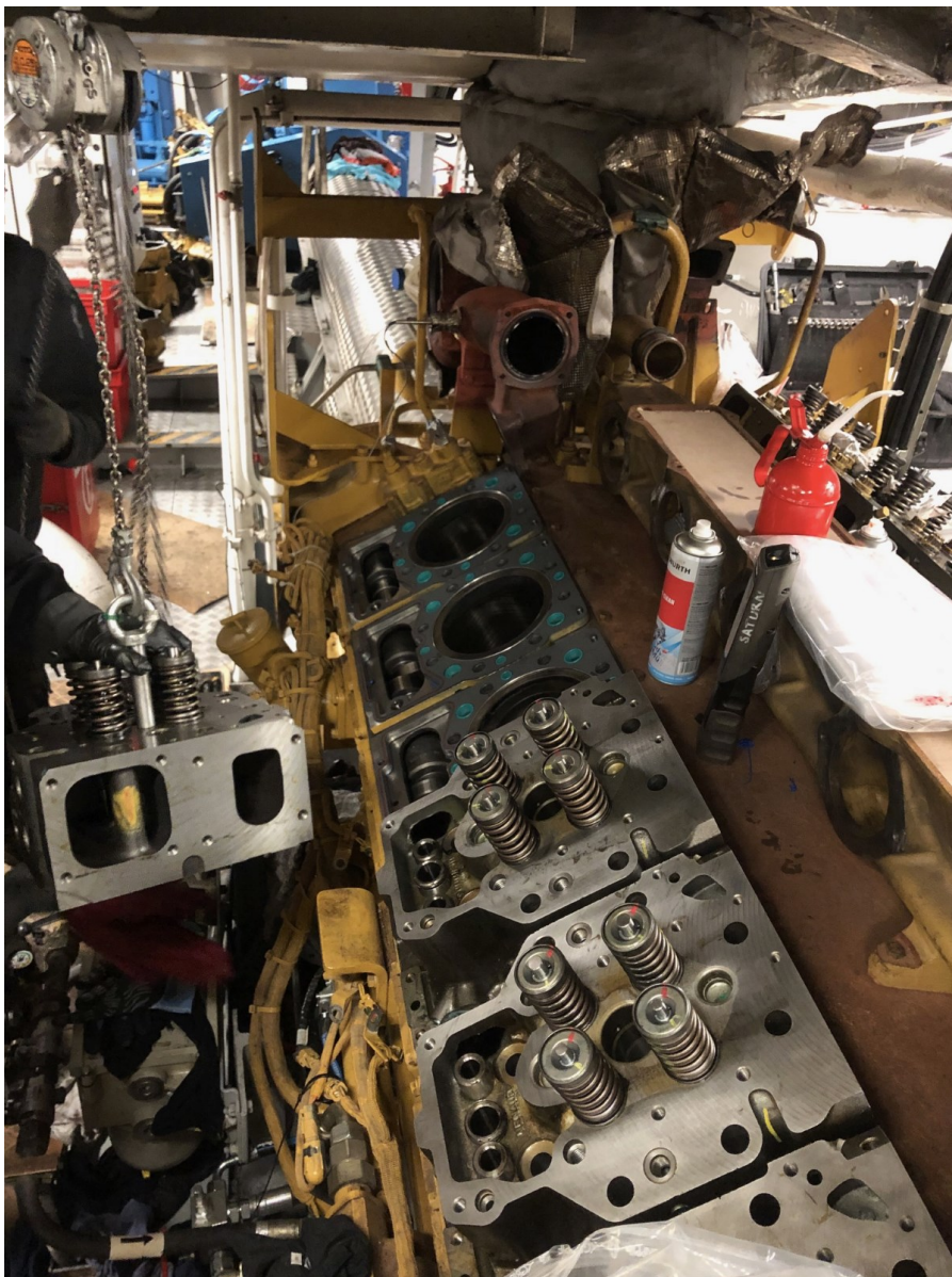
Kuva 21. Kansien paikoilleen nostoa. (Jari Perä 2020)
