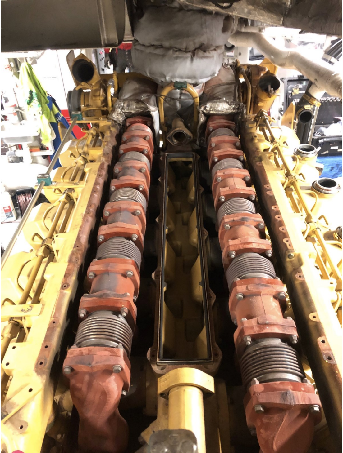
Kuva 10. Välijäähdytin poistettu. (Jari Perä 2020)
