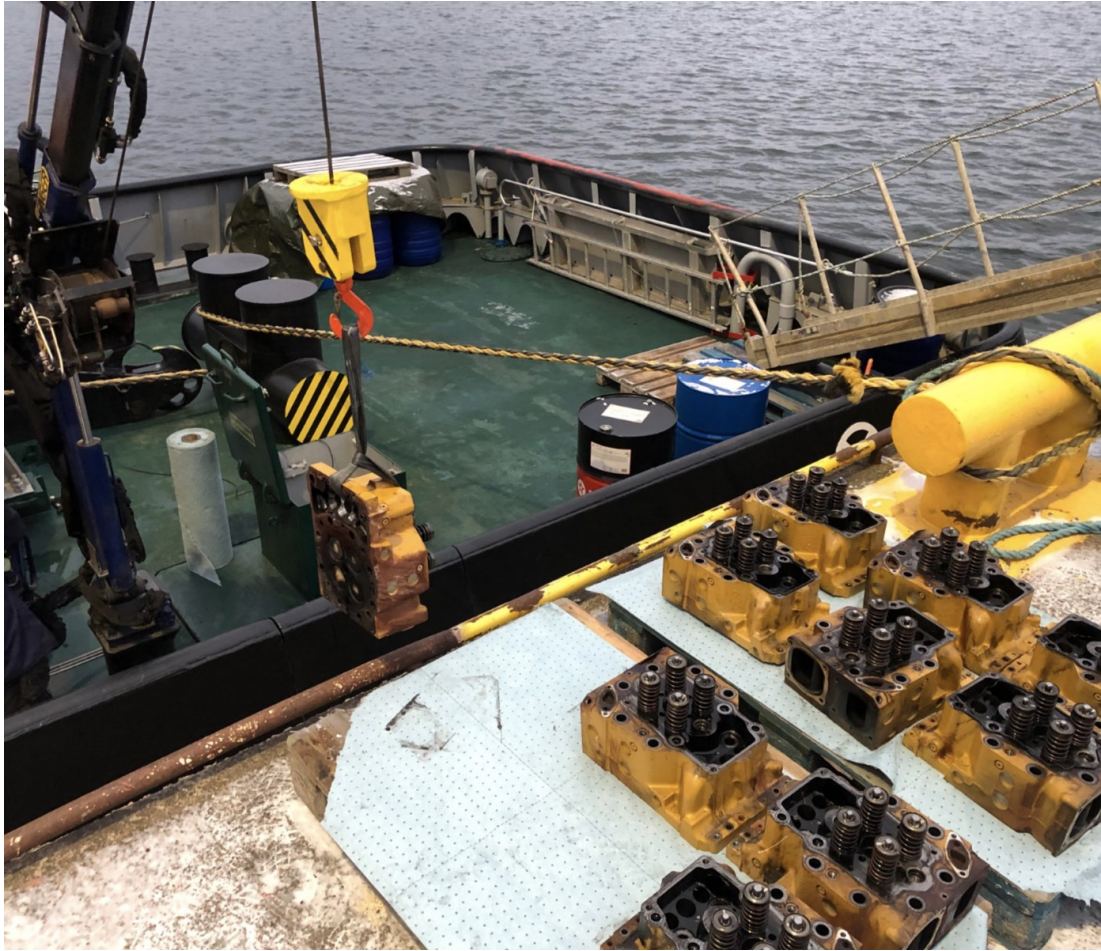
Kuva 13. Vanhojen sylinterinkansien nostoa. (Jari Perä 2020)
