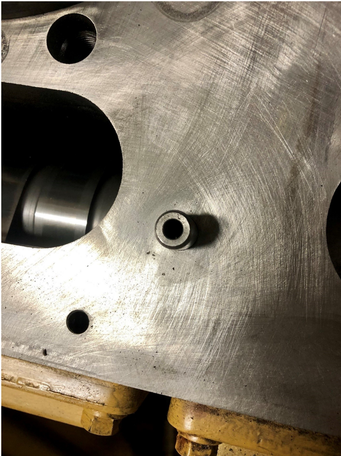
Kuva 15. Uusi voiteluöljyn annostelutappi. (Ole Desler 2020)
