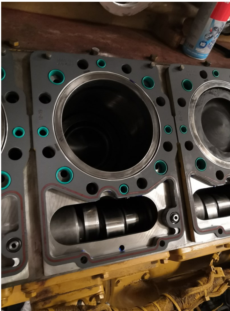
Kuva 20. Välilevy sekä metallitiivisteet. (Mikael Peltonen 2020)
