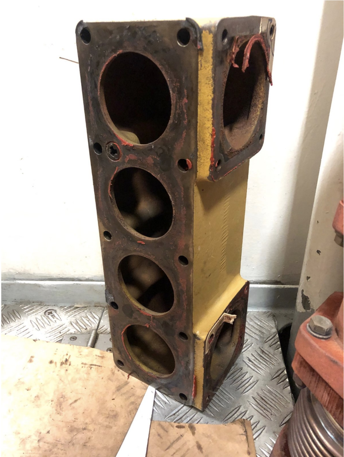
Kuva 19. Termostaattien kotelo odottamassa puhdistusta. (Jari Perä 2020)
