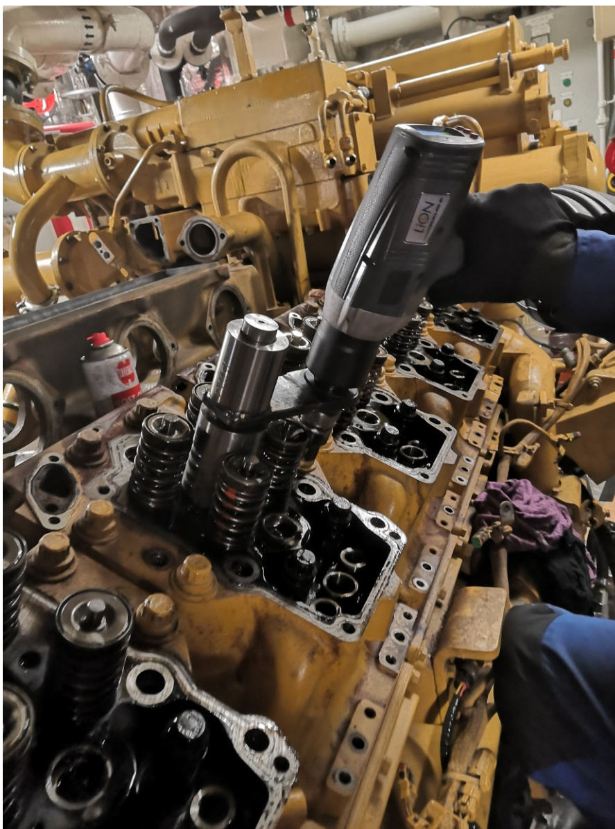
Kuva 12. Kannenpulttien irrotusta erikoistyökalulla. (Mikael Peltonen 2020)
