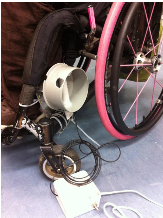
Kuvio 5. Asennusvaiheessa oleva palkkio-automaatti. Maassa ohjausyksikkö, joka kiinnitetään istuinosan alapuolelle.
