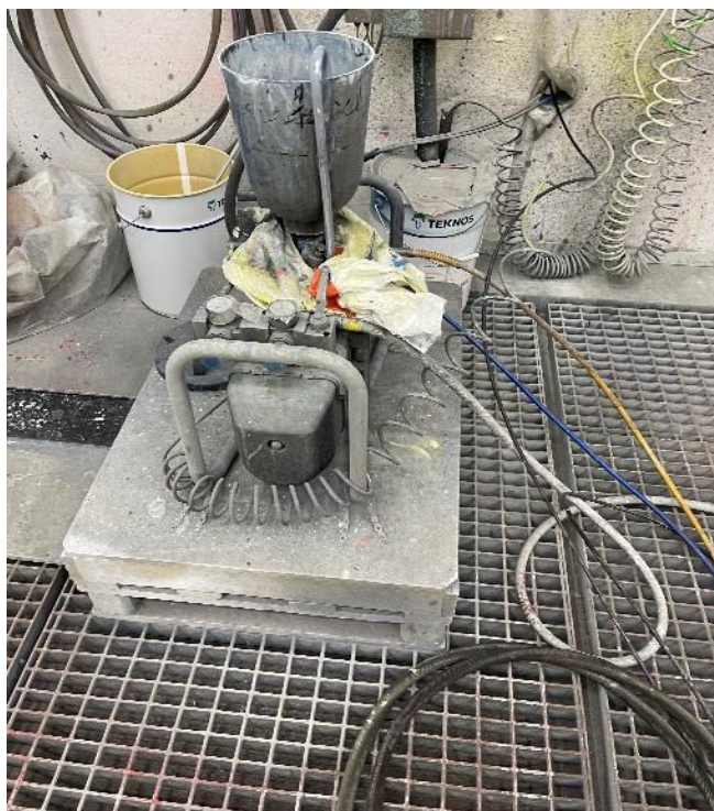
Kuva 19. Liutiinohenteisten nestemaalien maalauksessa käytetty ilma-avusteinen suurpaine-ruisku.
