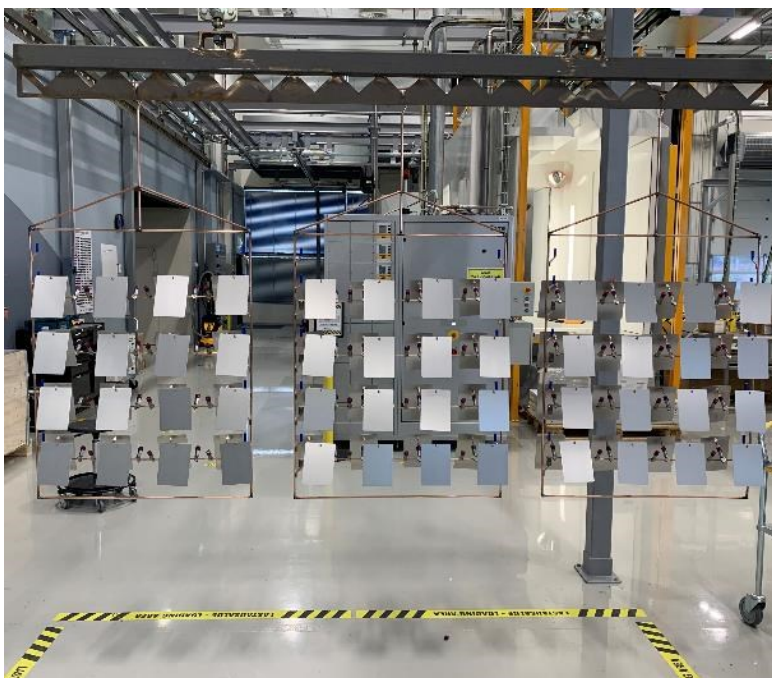
Kuva 15. Jauhemaalaukseen menevät Q-panel-teräslevyt ripustettuna kuljetinlinjastoon.
