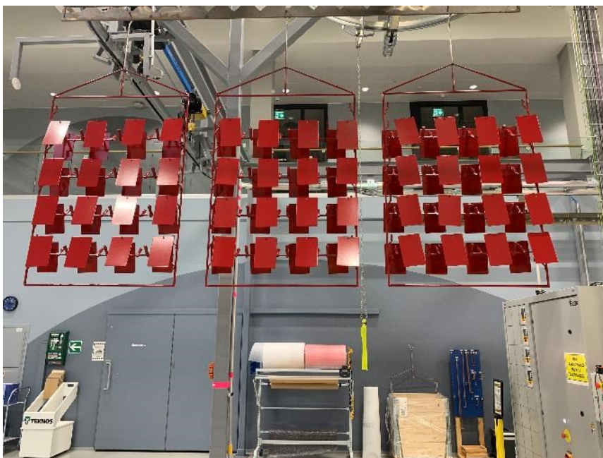
Kuva 17. Uunituksen jälkeiset polyesterijauhemaalatus levyt jäähtymässä.
