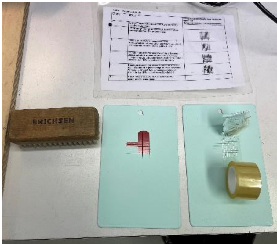
Kuva 26. Hilaristikkotestattujen levyjen arviointi käynnissä.
