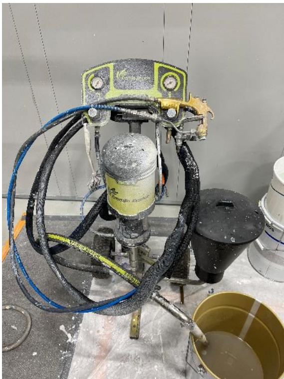
Kuva 18. Vesiohenteisten nestemaalien maalauksessa käytetty ilma-avusteinen suurpaineruisku.
