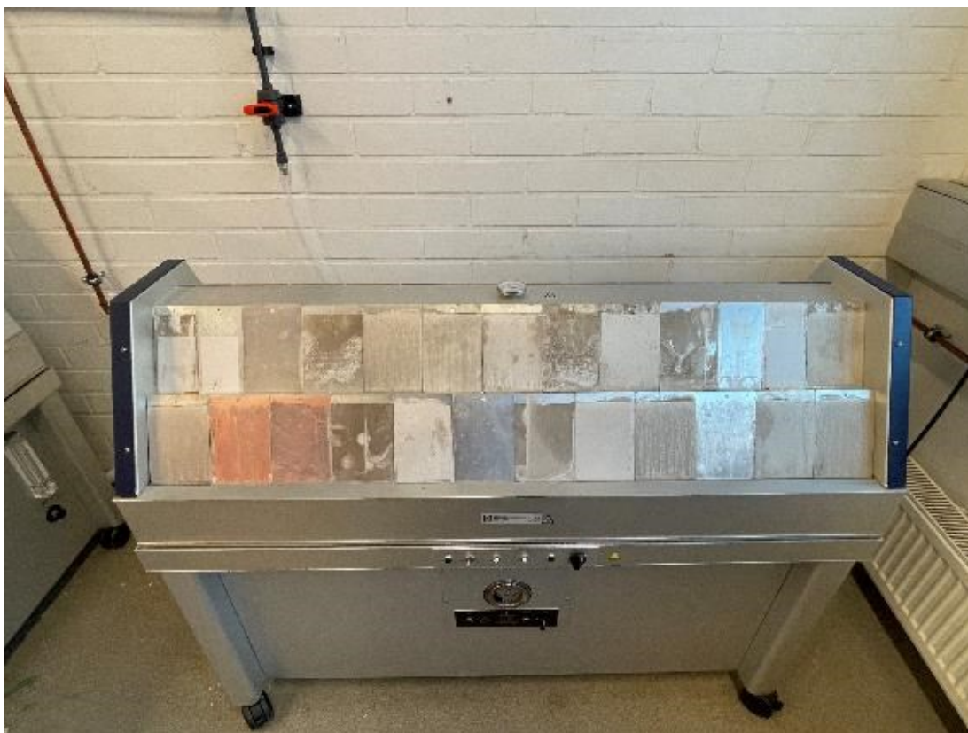
Kuva 28. Tutkimuksessa käytetty kondenssitestilaitteisto. Laitteistossa on kiinni peitekappaleet, joilla peitetään laitteisto, kun kondenssittesti ei ole käynnissä.
