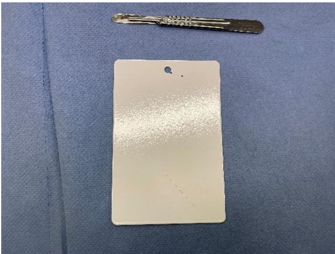
Kuva 24. Veitsikokeessa tarvittavat kirurgin veitsi sekä koelevy.
