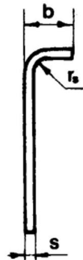
KUVA 11. Teräsohutlevyjen laippakorkeuksia, kun r_s = s . (Karppinen 1986, 43.)
