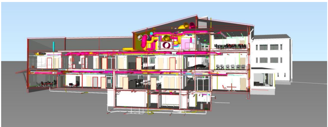
KUVA 1. Leikkauskuva rakennuksen yhdistelmämallista
