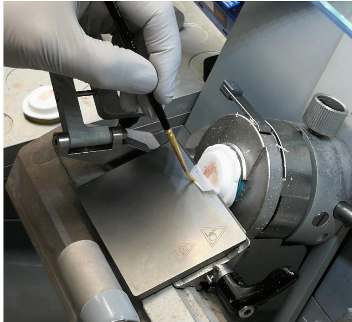
Kuva 3. Jääleikkeen leikkaaminen kryostaatilla. (Emmi Sillankorva)
