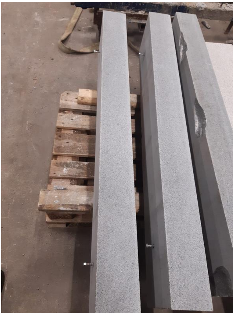
KUVA 11. Reunakiven pohjaan asennettu betoniruuvit (Juuso Aaltonen 2021)
