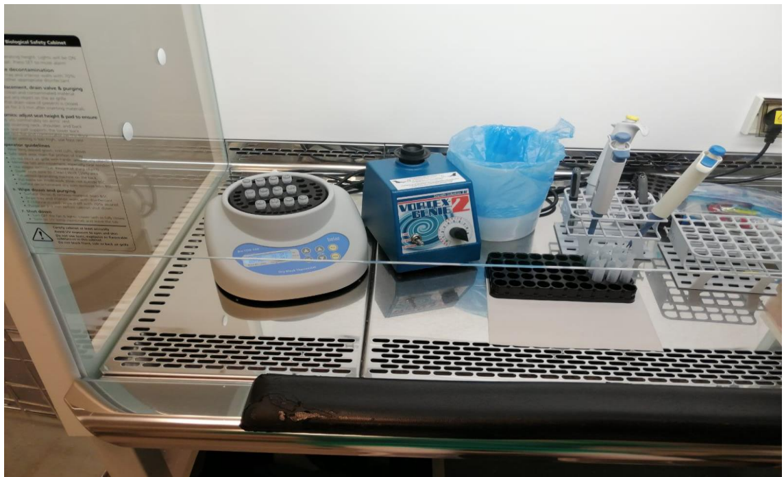
Kuvio 5. Kuva näytteiden esikäsitelyssä käytettävästä biosuojakaapista. Vasemmalta oikealle: lämpökuoppalevy, jossa 12 SPC putkea, sekoittaja, roska-astia, puskuriampulleja mustassa telineessä, pipetit ja takana käsitellyt näyteputket suoja-pakkauksessa kylmägeelissä. Kuva Mikko Hiltunen.
