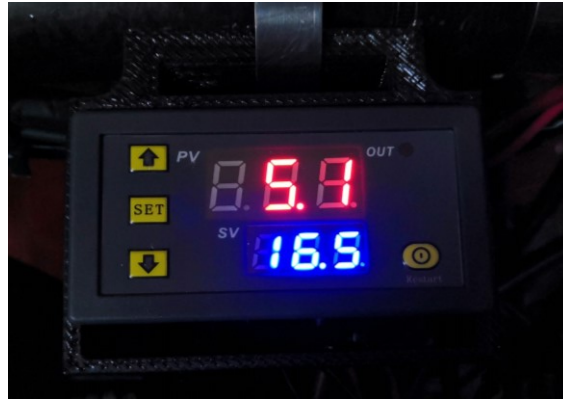
Kuva 11. Tuulettimenohjain. Punaisilla numeroilla on mitattu lämpötila ja sinisillä valittu lämpötila, jossa tuuletin käynnistyy.
