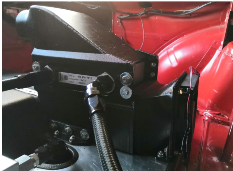
Kuva 10. Jäähdytinjärjestelmä asennettuna autoon. Oikeassa reunassa on tuuletin, joka vetää ilmaa jäähdyttimelle ja ilma poistuu vasemmassa yläkulmassa olevan letkuliitännän kautta.
