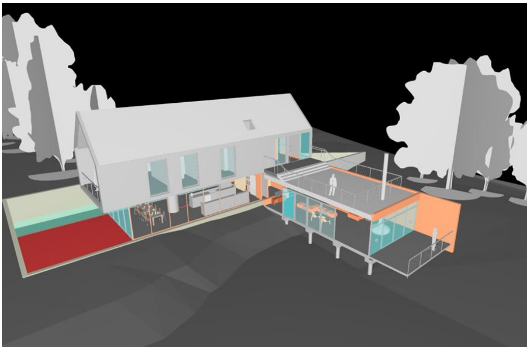
KUVA 7. Dialux Evo-ohjelmaan avattavasta IFC-tiedostosta valitaan, kuinka tarkasti ja mitkä objektit rakennukseen tuonnin yhteydessä siirretään.
