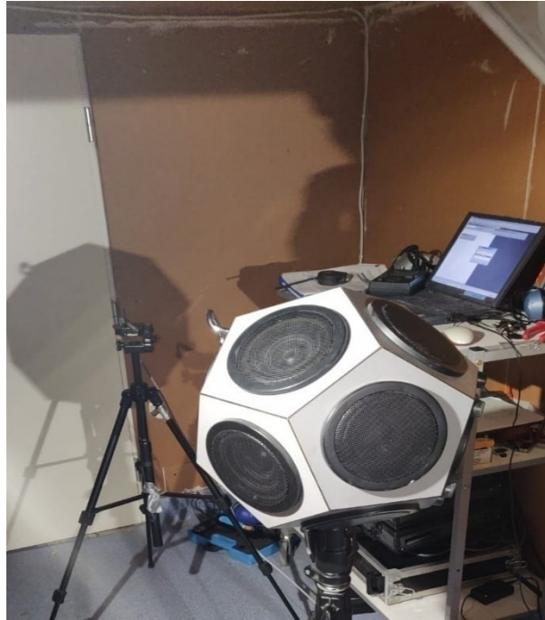
Kuva 6: Äänilähde ja lähetävää ääntä mittaava mikrofoni omassa telineissään.
