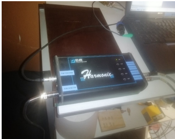
Kuva 7: Harmonie 4210 mittauslaitteisto kytkentöineen.
