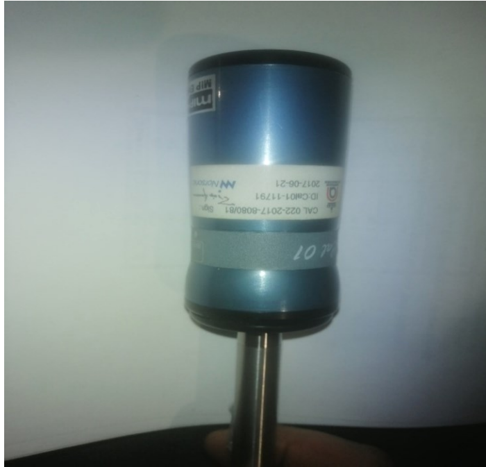
Kuva 8: Vastaanottava mikrofoni kalibrointiasennossa 94 dB:llä.
