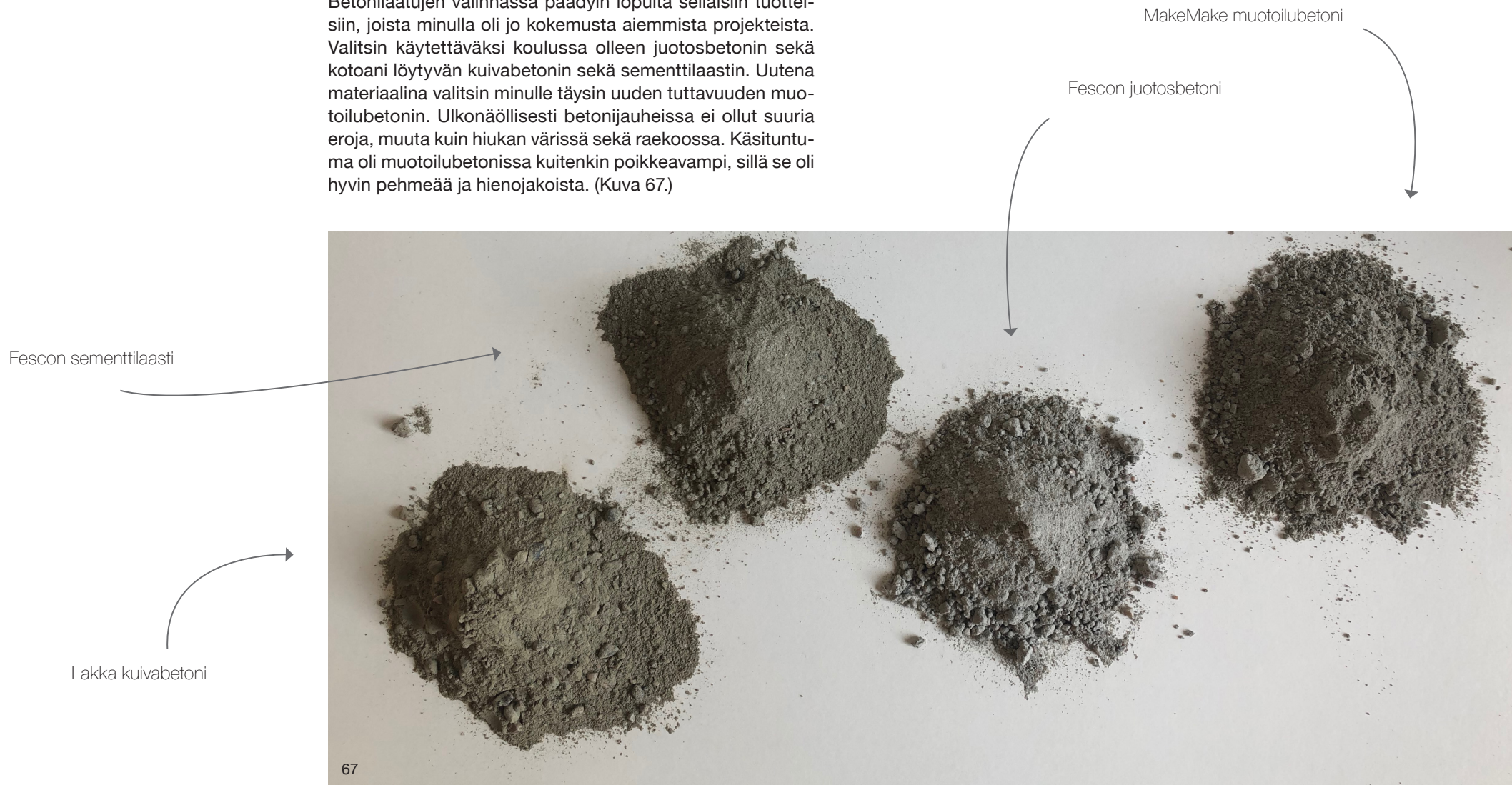
Kuva 67. Projektissa käytettäviä betonilaatuja.
