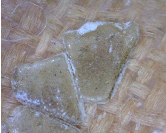
Kuva 28. Kalotin kuvun päällimmäisen silkkikankaan vahatahroja. (DinoLite-kuva noin 200-kertainen suurennos).
