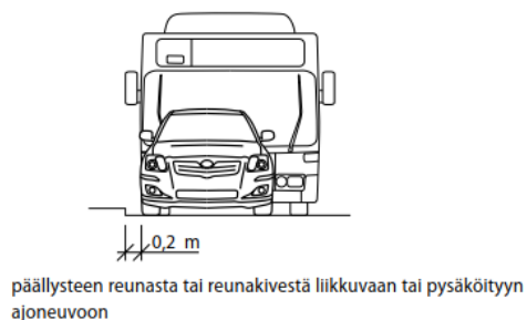
Kuva 34. Ajovara reunakiveen (Rakennustieto Oy, 2016b).
