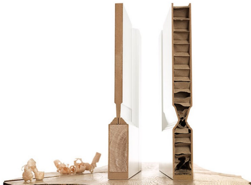
Kuva 75. Massiivioven ja kevytoven ero. (Jeldwen, julkaisu-aika tuntematon).
