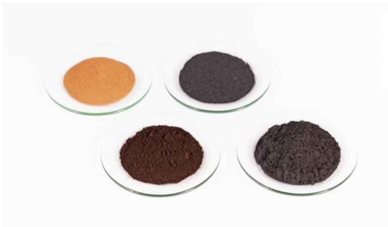
KUVA 14. Ligniinistä tehtyä anodimateriaalia Stora Enson koelaitoksella Sunilassa (Forest 2020)
