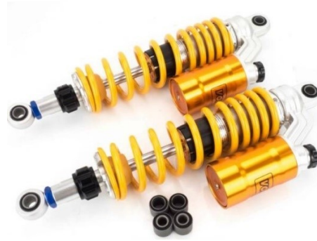
Kuva 15. Säädettävä teleskooppivaimennin lisäsäiliöllä (Mtp-racing24 2021).
