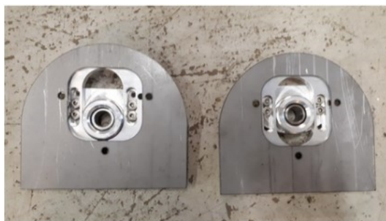
Kuva 11. Säädettävä joustintuen yläkiinnitys (Uniball 2021).
