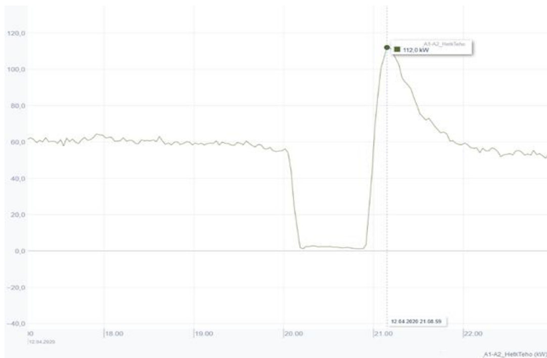
KUVA 30. Oppilaitoskiinteistö A:n patteriverkoston hetkellisen tehon trendi
