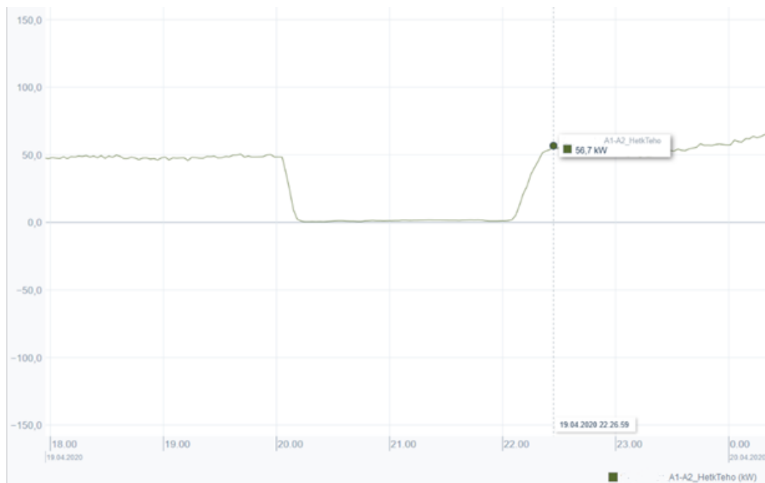
KUVA 31. Oppilaitoskiinteistö A:n patteriverkoston hetkellisen tehon trendi
