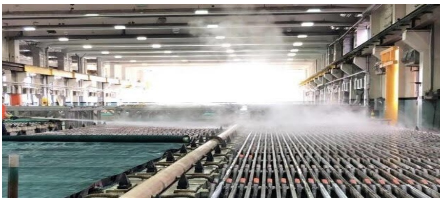
Kuva 19. Elektrolyysialtailta haihtuvaa vesihöyryä. Kuva: Boliden Harjavalta
