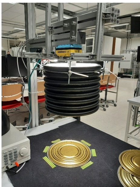
Kuva 13. Testi Cognex 5403 -kameralla ja yrityksen vanhalla valaisujärjestelmällä
