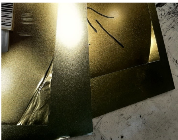
Kuva 8. Metallikansien valmistusmateriaalien sävyeroja
