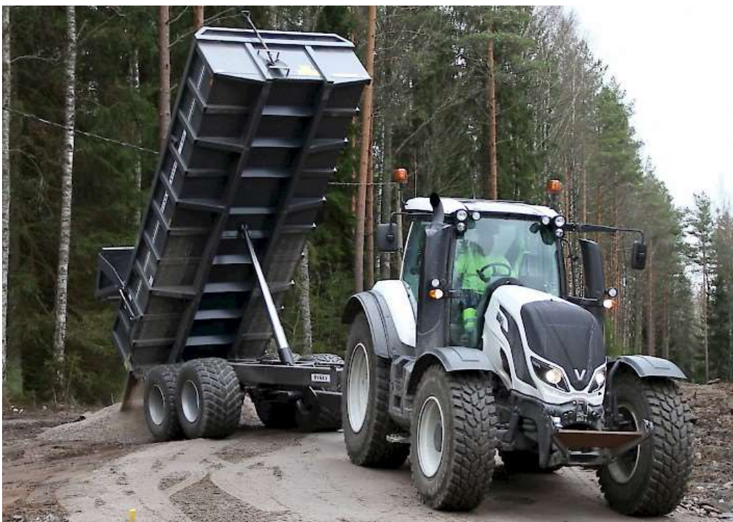
KUVA 4. Traktori ja kippaava peräkärri (22)
