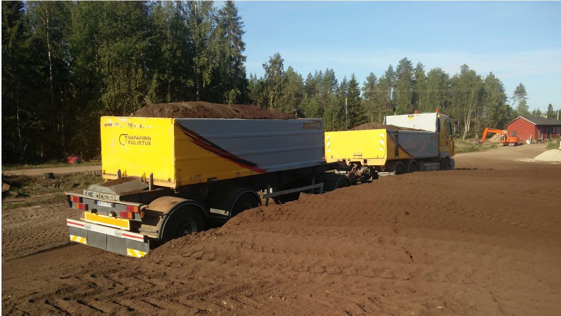
KUVA 10. Kuvassa lastattuna kevyttä multaa, joka ei saavuta täyttä kantavuuspainoa ajoneuvossa
