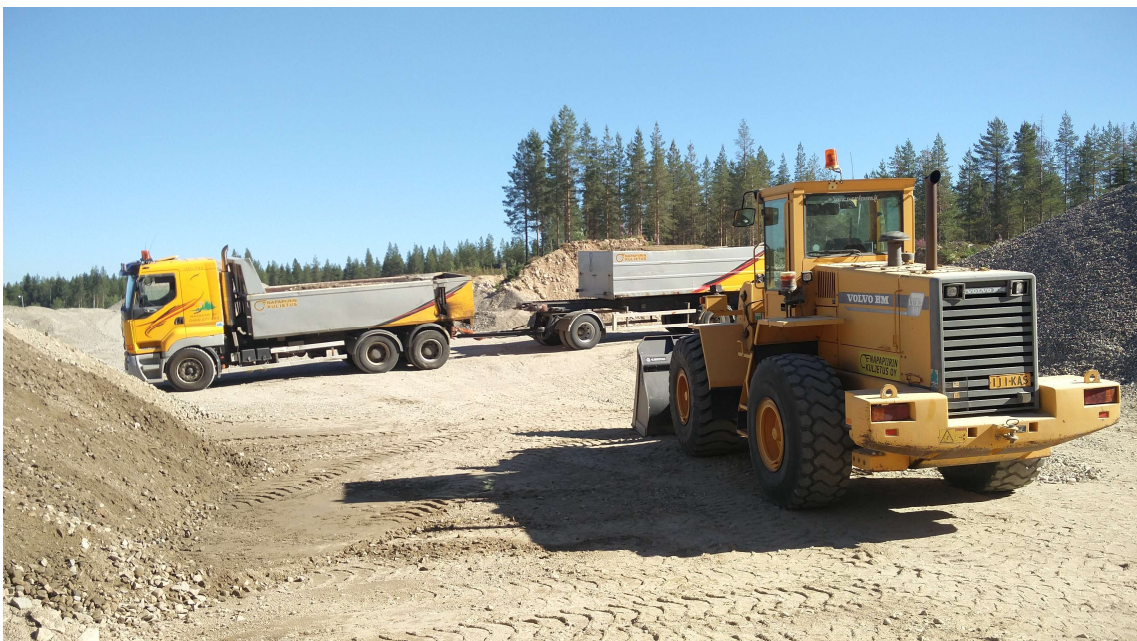
KUVA 1. Kuorman lastauksessa käytettävä pyöräkuormaaja ja kasettiauto
