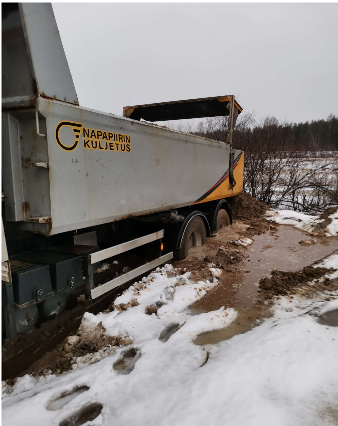
KUVA 12. Läjitysalueelle painunut kuorma-auto
