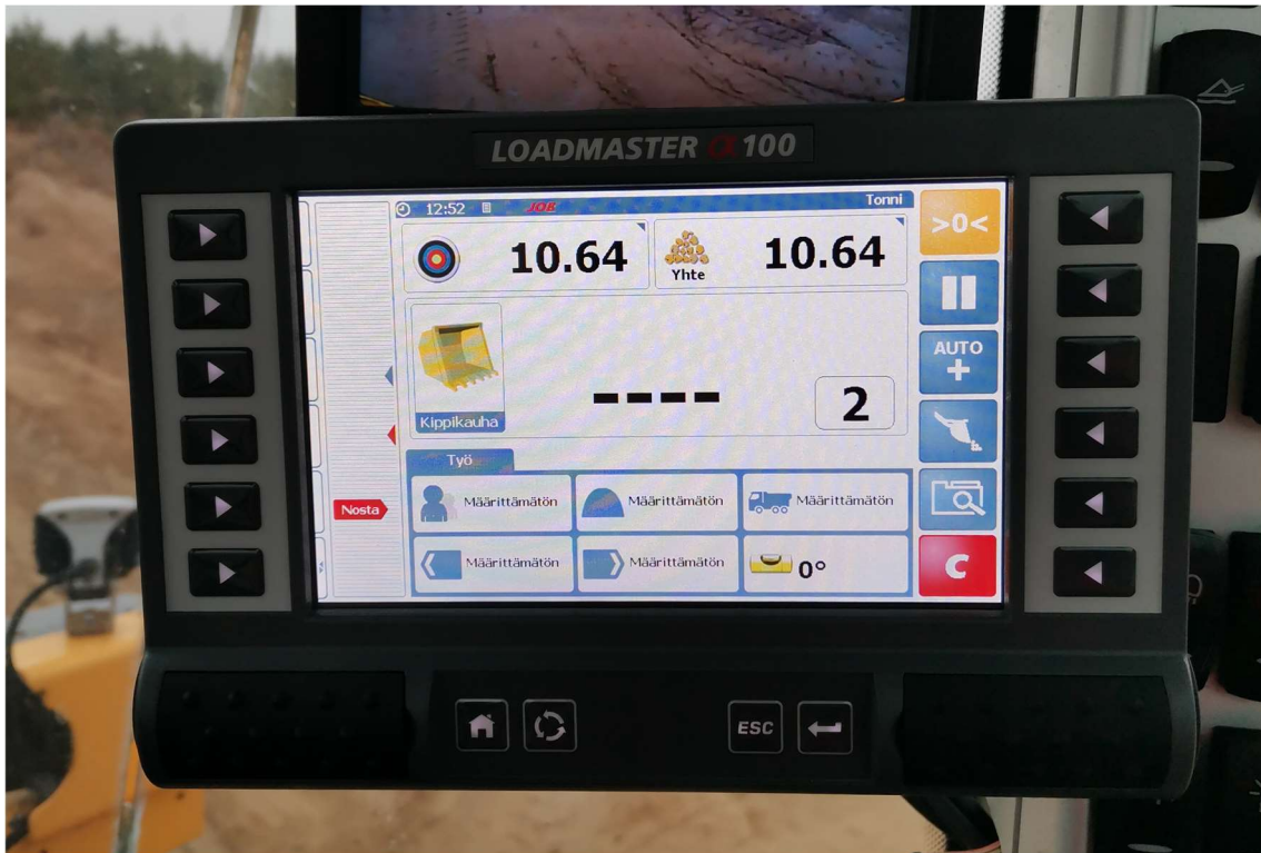
KUVA 11. Kuvassa vaakajärjestelmän näyttöpääte, josta seurataan lastattavan ajoneuvon kuormapainoa
