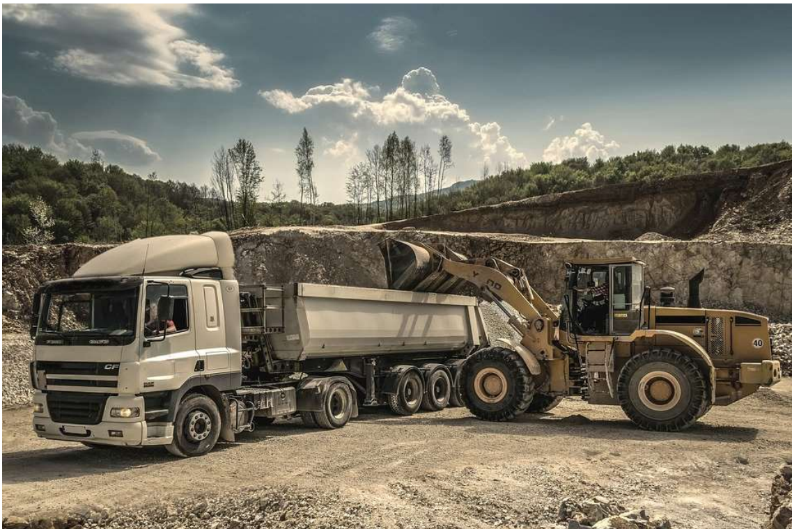
KUVA 8. Pyöräkuormaaja lastaamassa puoliperävaunua (24)
