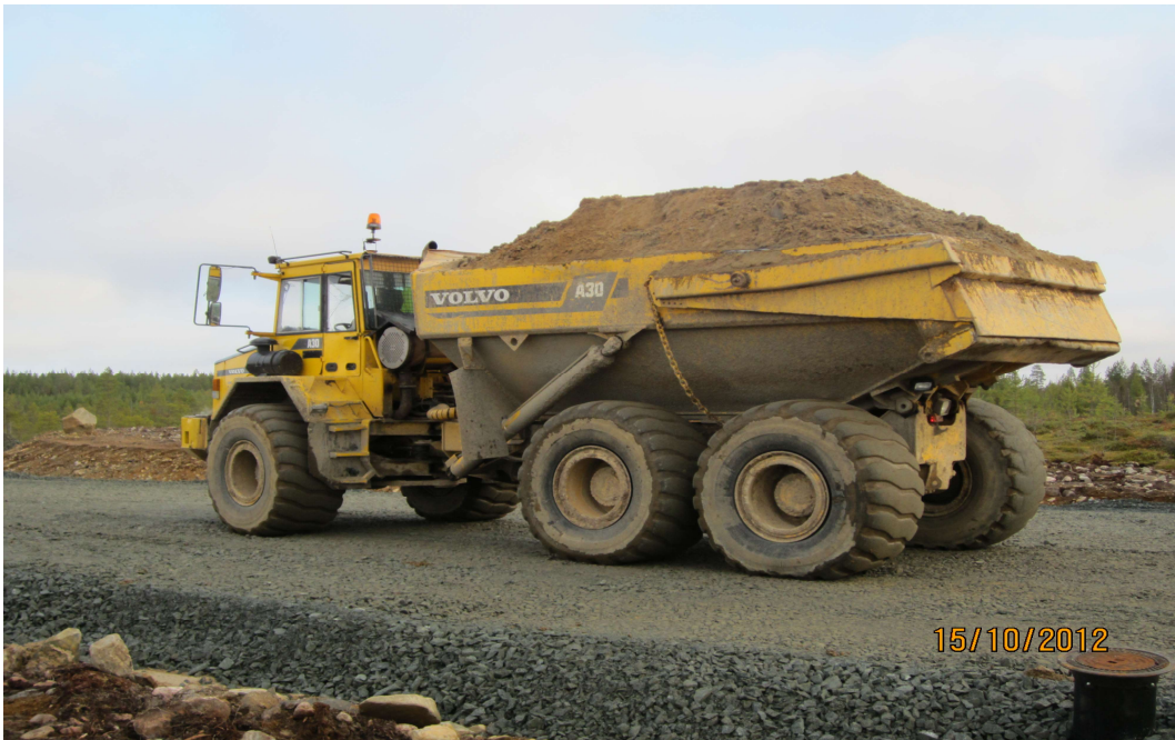
KUVA 3. Runko-ohjattu traktori eli dumpperi (21)
