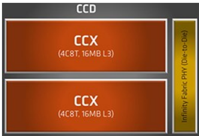
Kuva 2. CCD on siru, joka sisältää kaksi CCX:ää (Sandhu, 2019)
