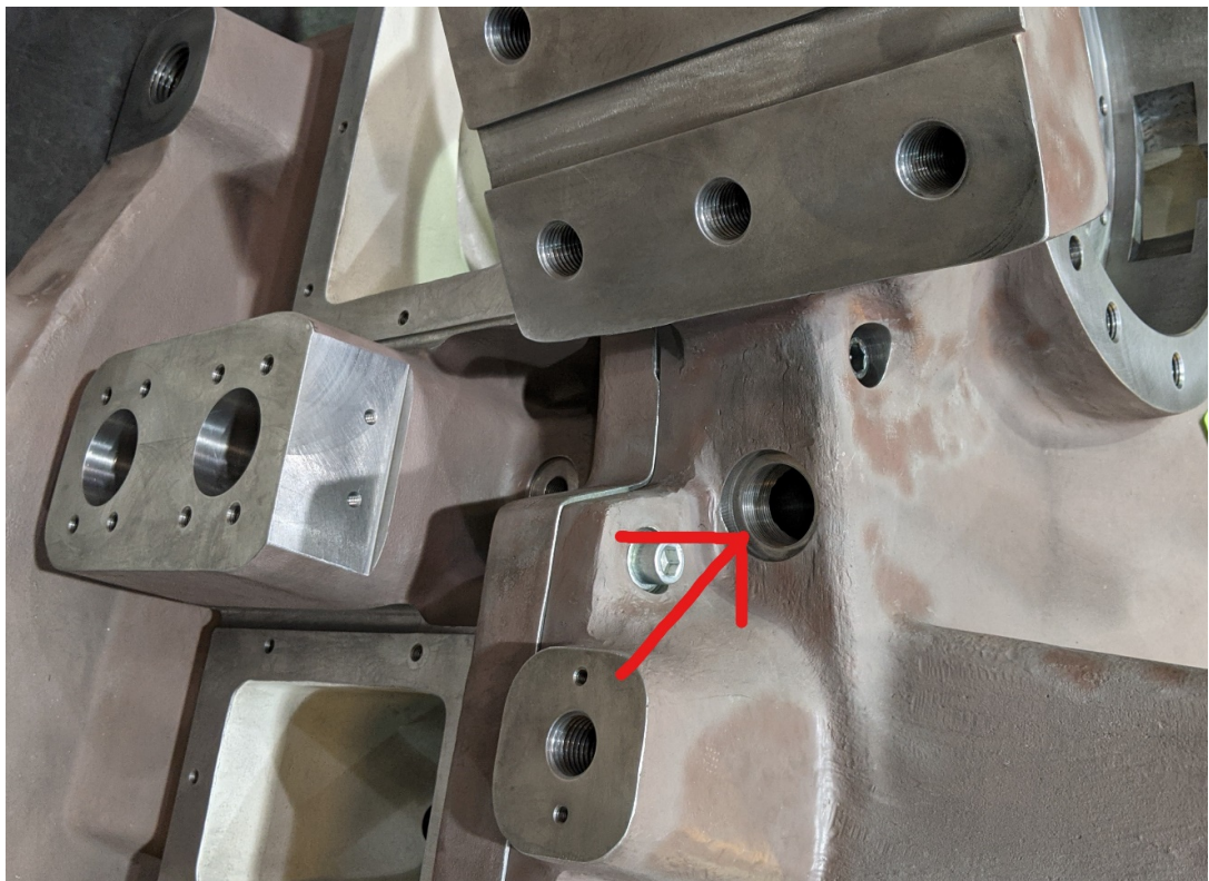
Kuvio 9. Esimerkki porauksesta, joka tarkastetaan silmämääräisesti
