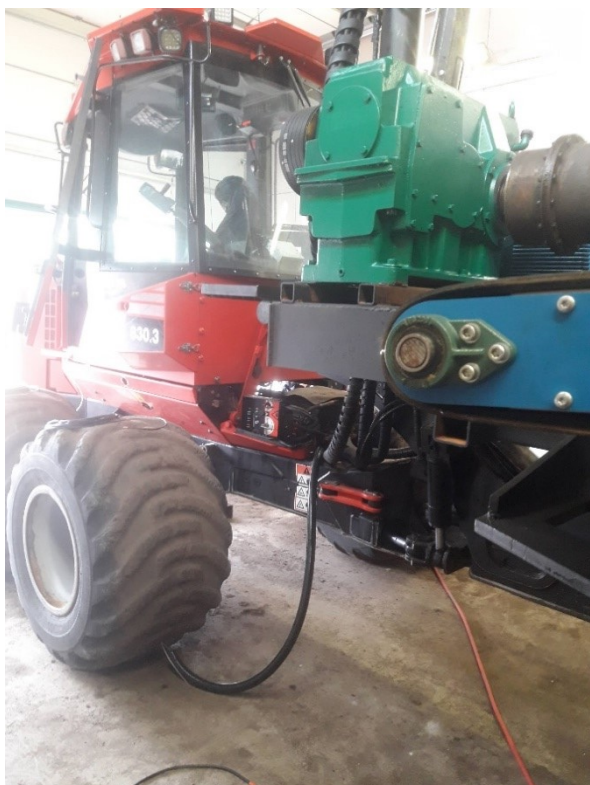
Kuva 23. Koneen kääntönivel ja kaapelien suojausputki.
