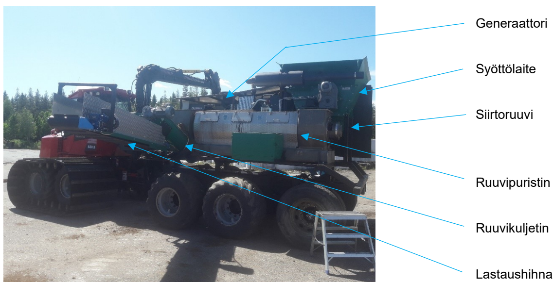
Kuva 2. Sammalkoneen rakenne
