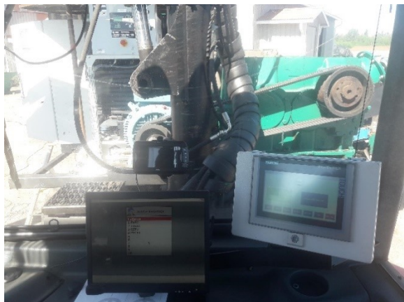
Kuva 25. HMI-paneeli asennettuna kuljettajan näkökenttään.
