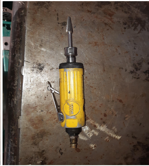
Figur 7, Luftdriven roterande fil
