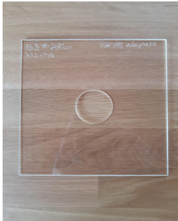
Figur 3, Kalibreringsskiva från Flow Performance
