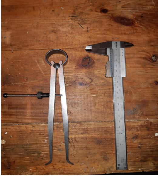
Figur 6, Fotpassare till vänster och skjutmått till höger
