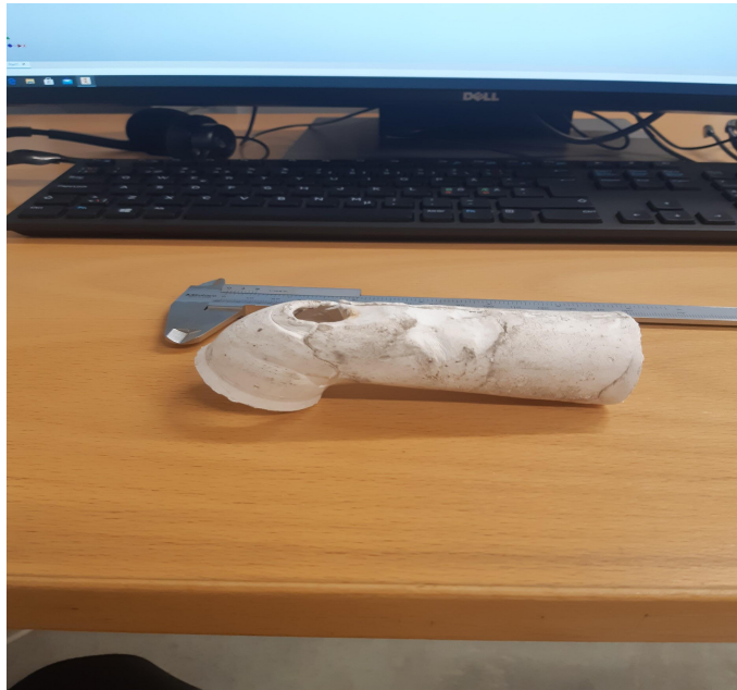
Figur 4, Avformad insugskanal i modellera
