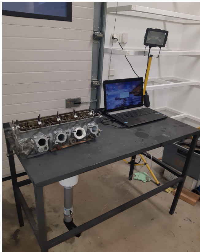
Figur 2, Flödesbänk med topplock monterat
