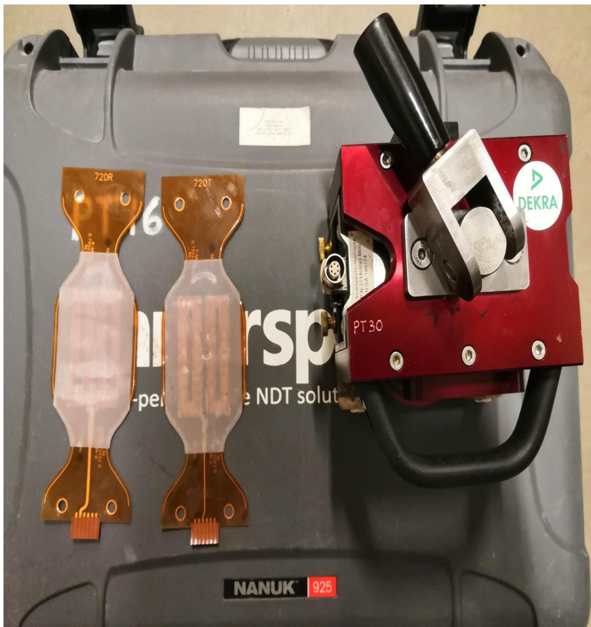
KUVA 13. Vasemmalla kuvassa 720 Receiver ja Transmitter RF-kela ja oikealla kestopagneetti johon RF-kela kiinnitetään (Nikka 2021).
