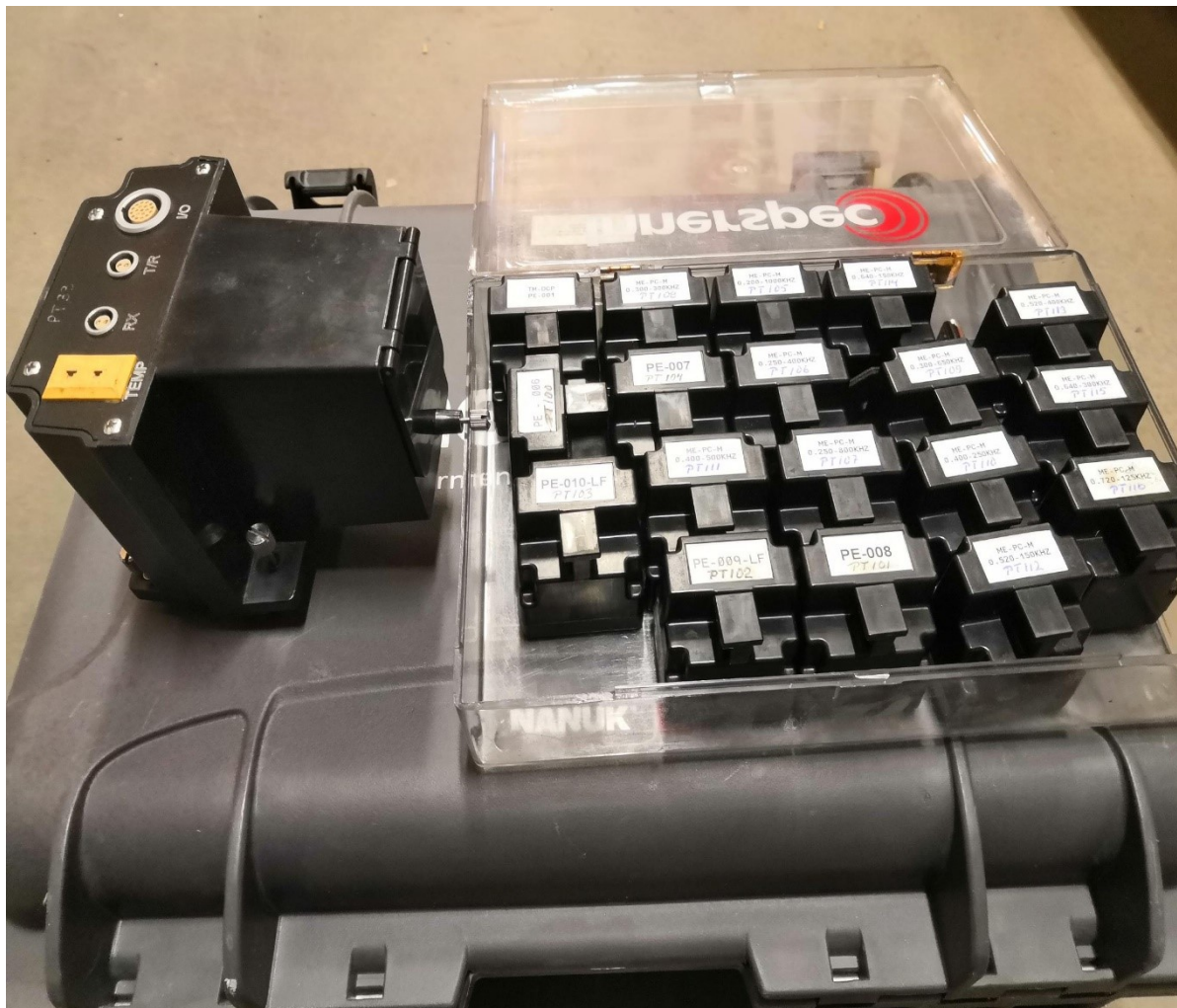
KUVA 14. Vasemmalla kuvassa signaalin säätölaatikko ja oikealla tuning moduuleja (Nikka 2021).
