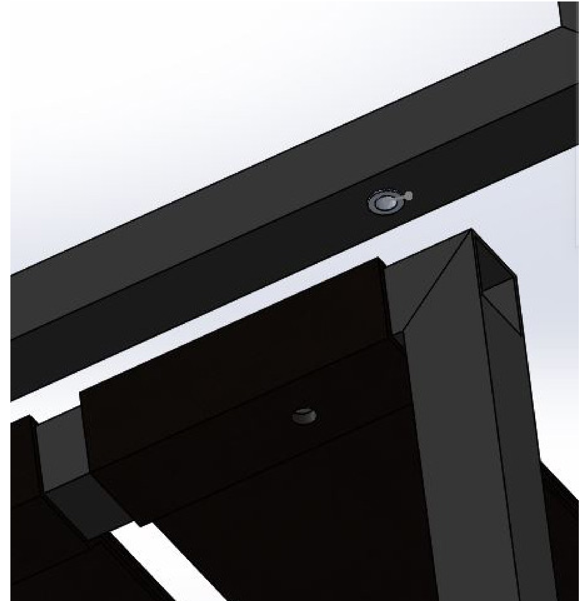
Lähikuva ja poikkileikkaus tuolin rakenteesta ja niittimutterista Solidworks-ohjelmassa.
