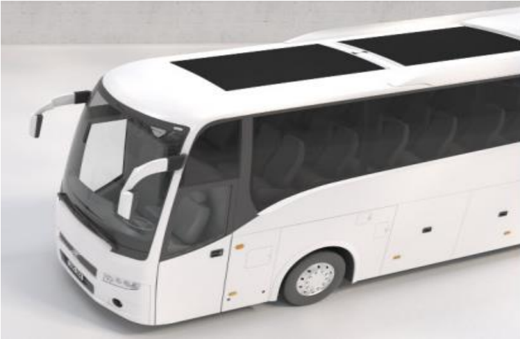
KUVA 4. Trailer aurinkopaneelit linja-autossa. (Trailar, 2)
