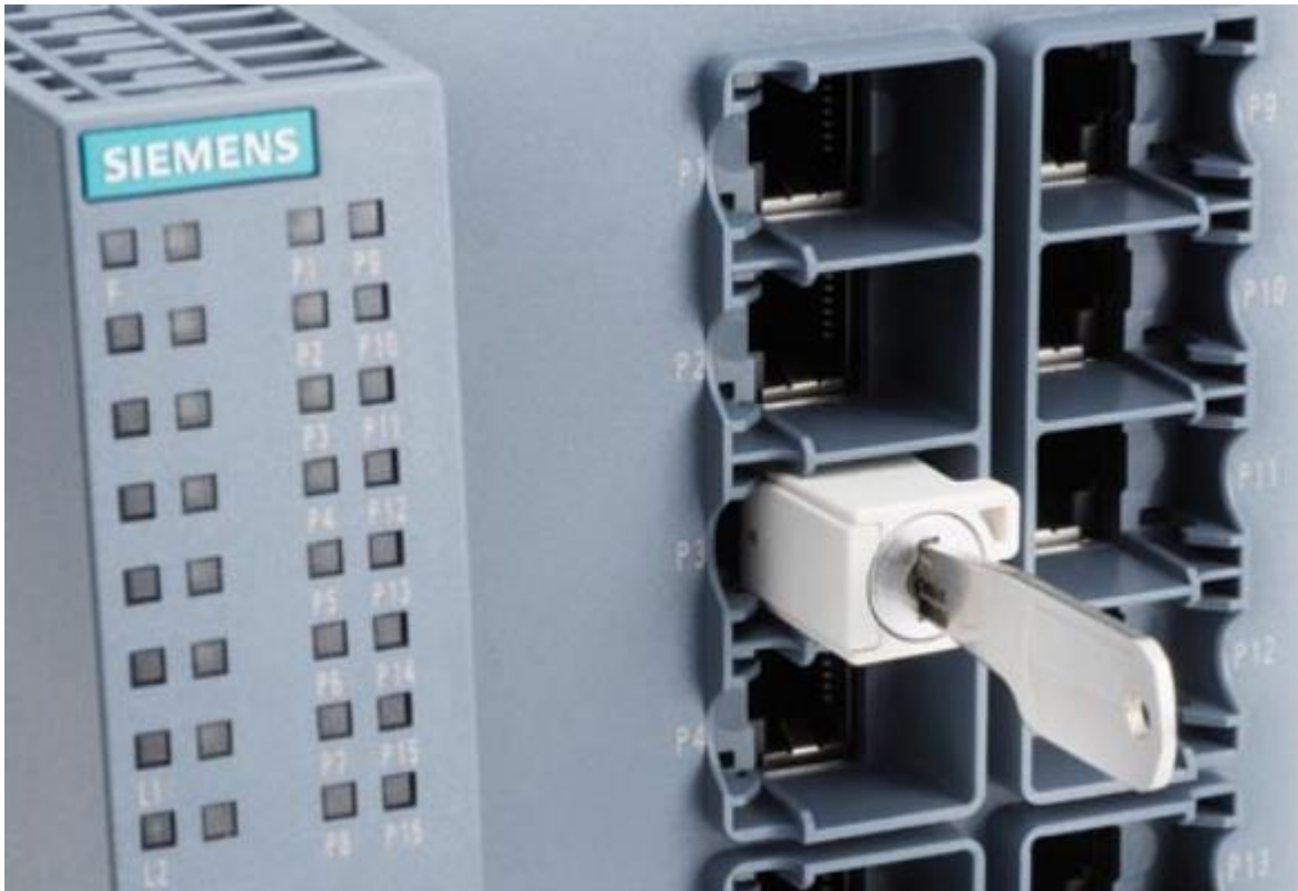
Kuvio 20. Siemensin RJ-45- lukko (IE RJ45 port lock N.d)
