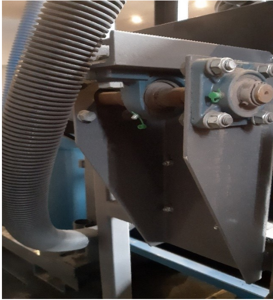
Kuva 18. Seulan kiinnitys epäkeskoakseliin
