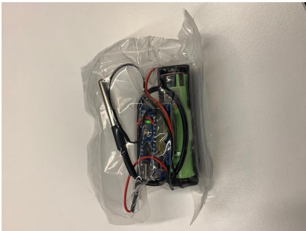
Kuva 10. Arduino nano vakuumissa (P.Mikkonen 2021)
