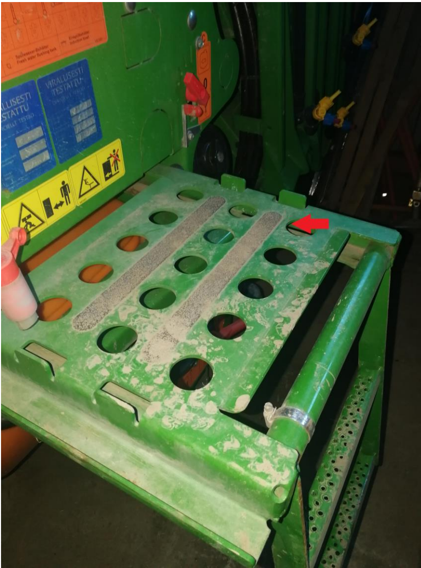
Figur 3: Friktionstejp monterad på växtskyddssprutans trappsteg © Haglund, 2021.
