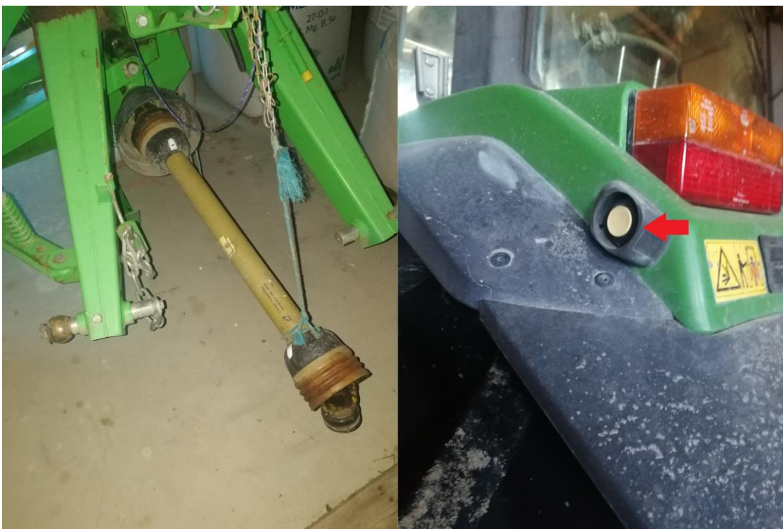
Figur 2: Bild på en kraftöverföringsaxel försedd med ett helt skydd samt nödstopp till traktorns kraftuttag © Haglund, 2021.
