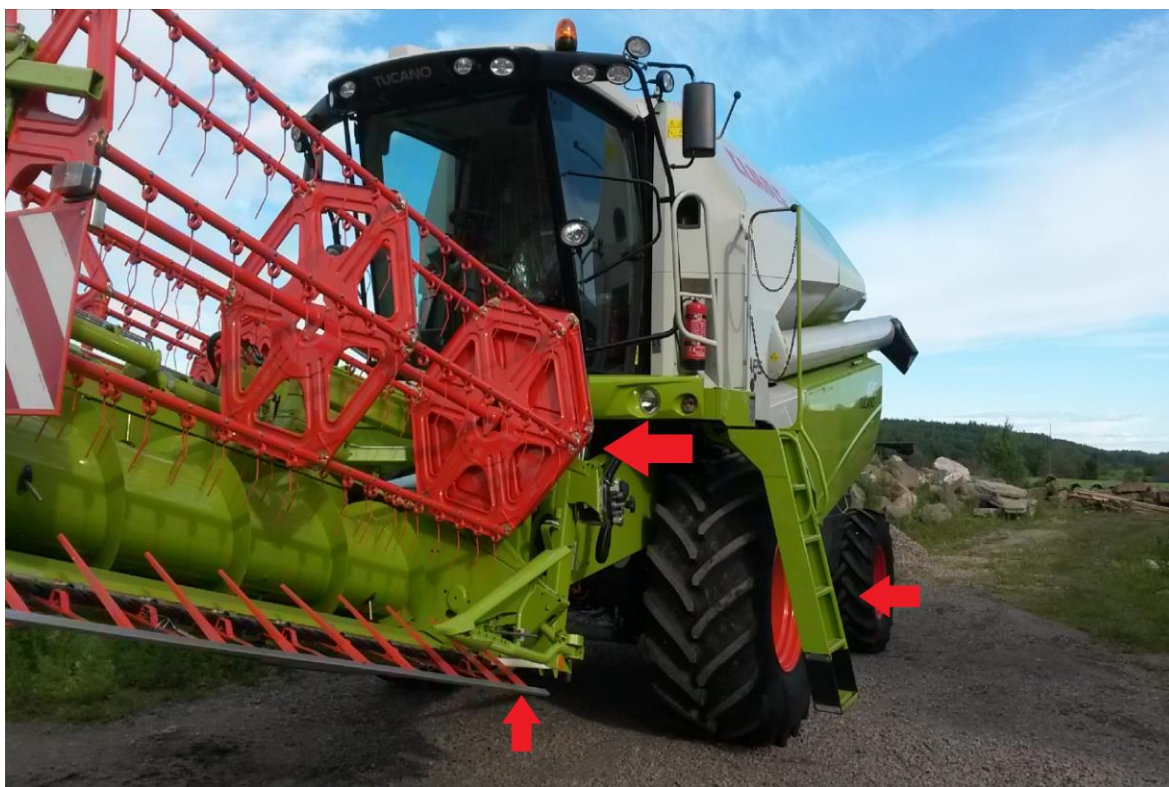
Figur 12: Bild på vissa riskfyllda delar på skördetröskan som bör beaktas vid användningen av tröskan © Haglund 2014.
