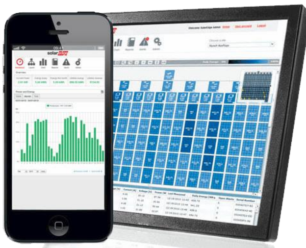
Kuva 5. Esimerkki aurinkovoimalan monitoroinnista sekä tietokoneella että mobiililaitteella. Kuvassa SolarEdgen käyttöliittymä. [13]
