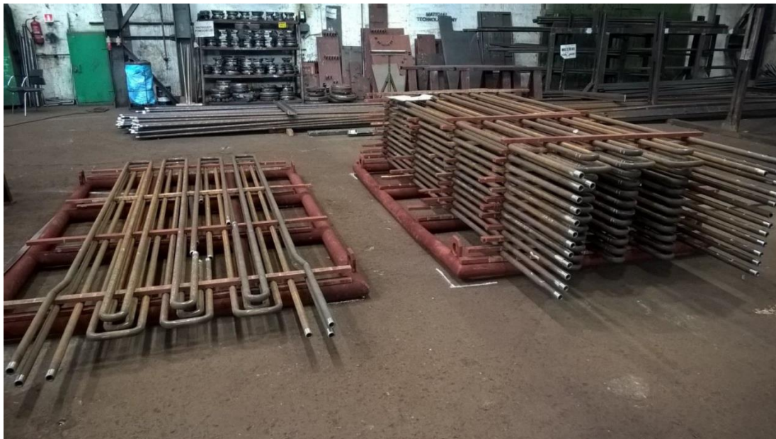
Kuva 5-2. Tulistinputkistoja valmistusvaiheessa (Valmet).
