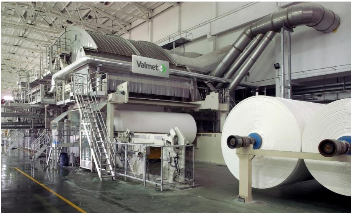
Kuva 2-2. Valmet Advantage DCT200 -pehmopaperikone (Valmet).
