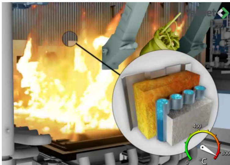
Kuva 4-6. Membraaniseinän rakenne (Valmet).
