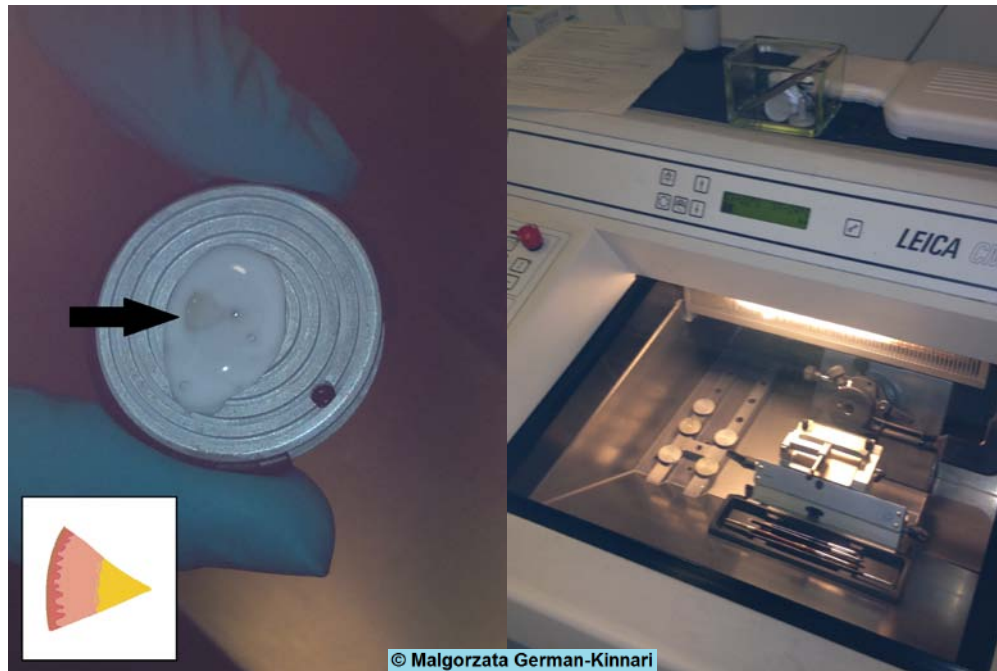
Kuvio 8. Vasemmalla: kyljelleen asetettu ja jäädytetty ihobiopsia tukiaineessa metalli-istukassa. Huomaa biopsian kiilamainen muoto; vasemmassa reunassa on ihon pinta ja oikeassa reunassa näkyvä kiilan kärki ulottuu oikeaoppisesti subkutaaniseen rasvakerrokseen saakka. Pikkukuvassa havainnoidaan ihobiopsian rakennetta (vertaa kuvioon 3). Oikealla: näyteistukat jääleikemikrotomissa.
