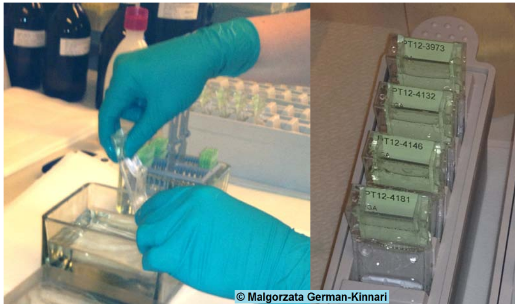
Kuvio 9. Vasemmalla: objektilasien laittoa inkubointikoteloihin. Oikealla: inkubointikotelot koteloidikkeessään.
