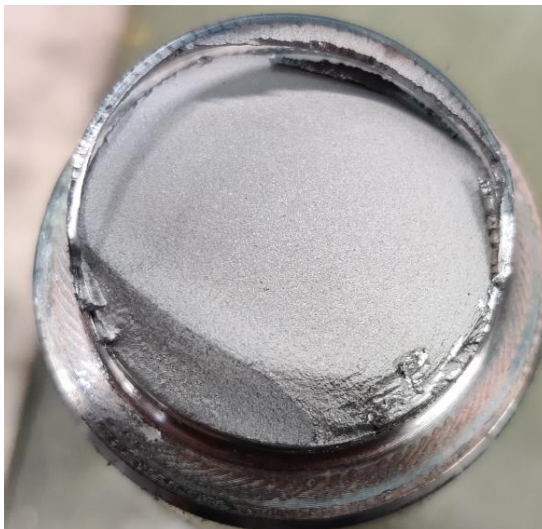
Kuva 18. Katkennut männänvarsi. Varren puolikkaat olivat toisissaan kiinni näkyvällä kierteenosalla.
