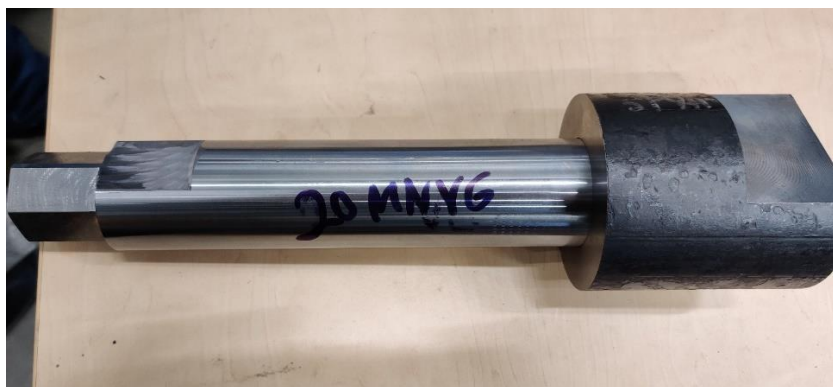
Kuva 14. Osat yhteen ruuvattuna ja männänvarren pätyyn on koneistettu samansuuntainen tartuntapinta männän tartuntapinnan kanssa.
