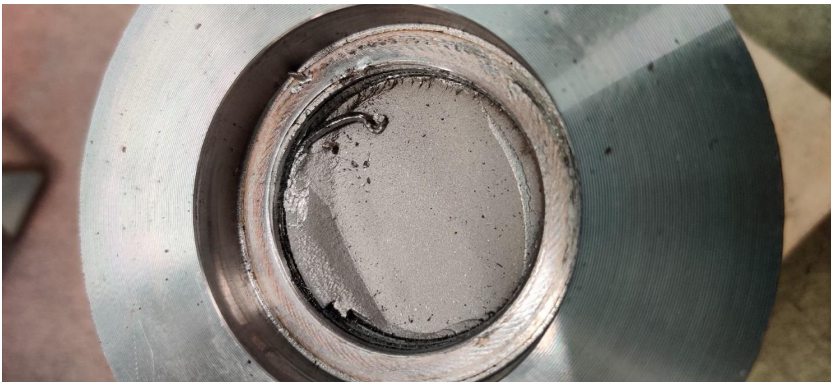
Kuva 21. Yleisnäkyvä männästä, jossa on katkennut männänvarren kierreosa sisällä. Näkyvissä on myös vastepinnalle ja kierteeseen koneistuksessa syntynyttä värinän tuomaa aaltomaista jälkeä.
