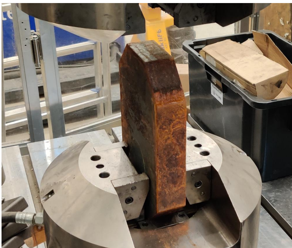
Kuva 24. Koneen rungon mittamuutosten selvittämiseen käytetty 50 mm paksu metallilevy.
