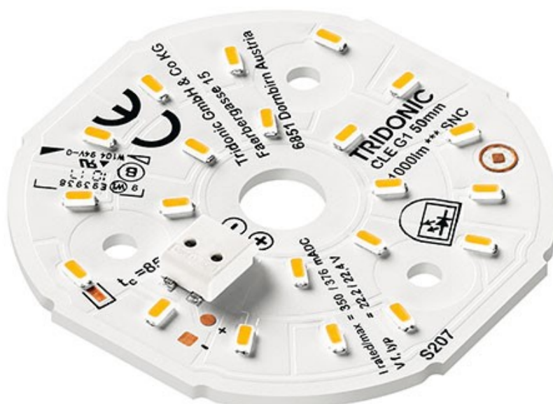
KUVA 4. LED-Moduuli, jossa liitäntä erillisen liitäntälaitteen vakiojännitteelle tai vakiovirralle. (Tridonic. 2021)
