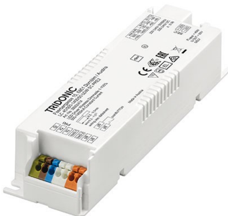
KUVA 7. Tridonic LC vakiovirta liitântälaite, virraltaan ohjelmoitavissa välillä 500-1400mA ja teholtaan 45W (Tridonic, 2021)
