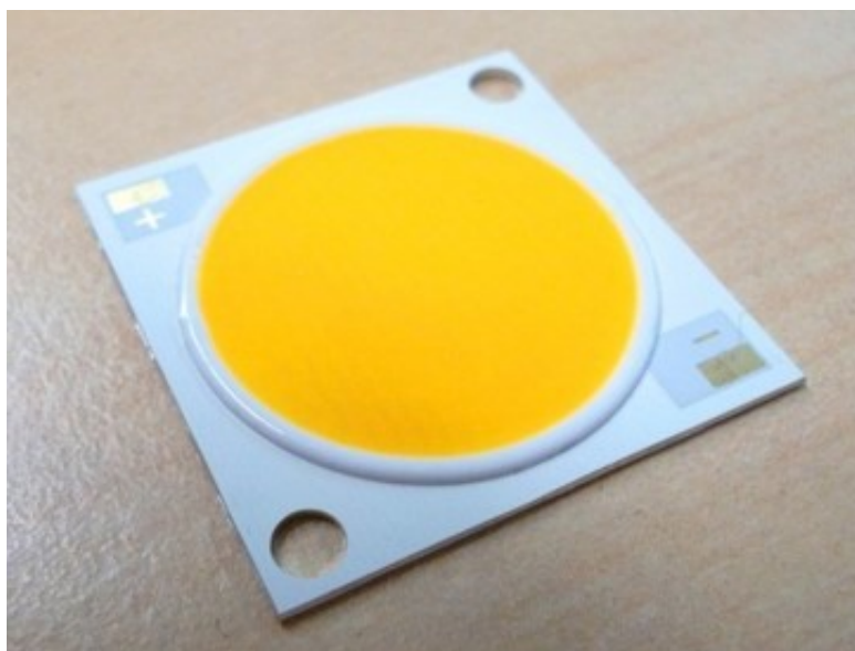
KUVA 3. Keltaisella fosforilla täytetty COB-LED.
