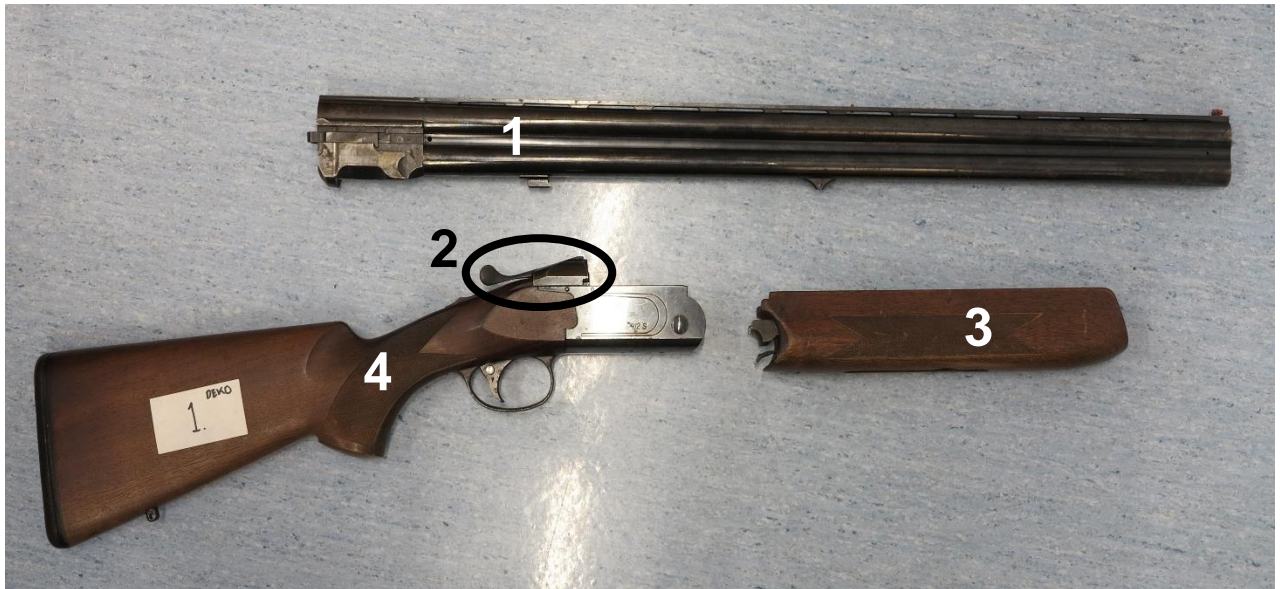
Kuva 5. Taittuvapiippuinen kertatulihaulikko ja sen osat (Kuva: Patrik Lapinlampi)
