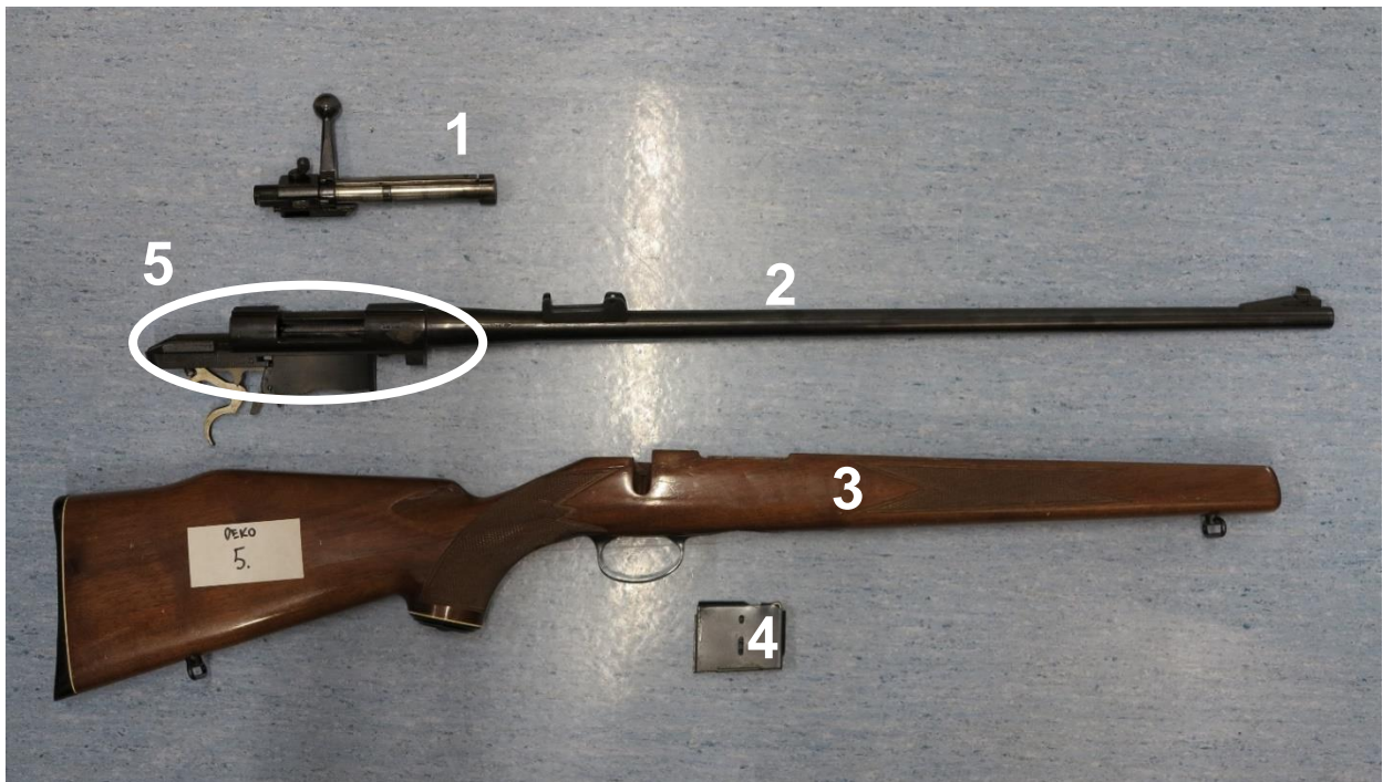
Kuva 3. Lippaallisen kertatulikiväärin osat (Kuva: Patrik Lapinlampi)
