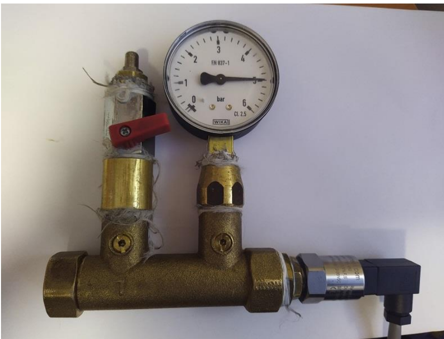
Kuva 5. Painetestaukseen rakennettu alusta.
