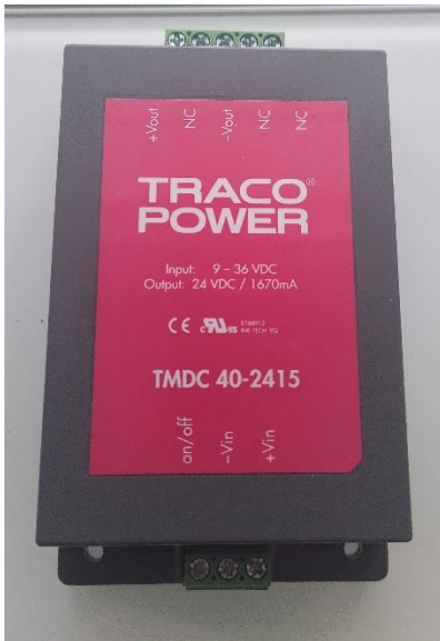
Kuva 6. Järjestelmään asennettava 24 V:n jännitemuunnin.
