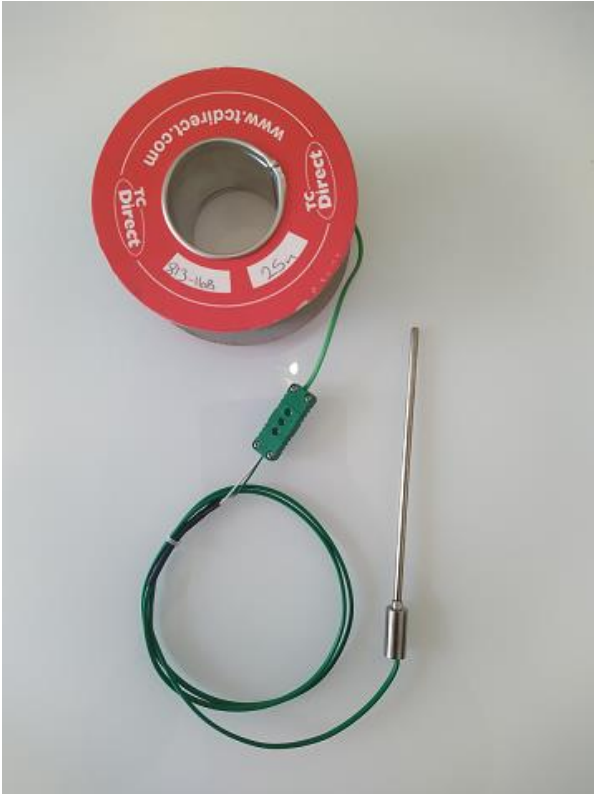
Kuva 4. Termoparianturi kytkettynä jatkokaapeliin.
