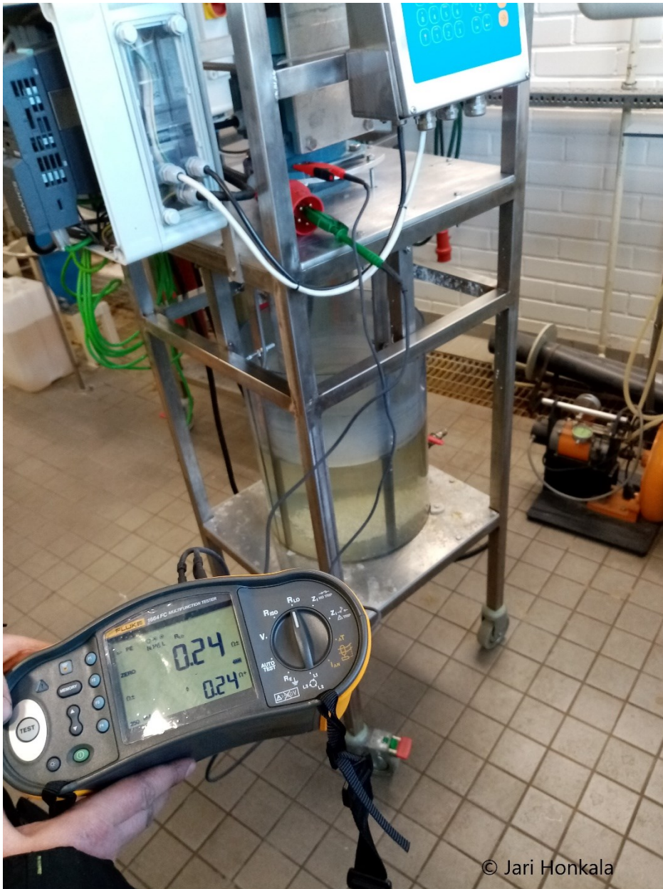
KUVA 4. Suojamaadoituspiirin mittaus pistotulpan ja sekoituslaitteiston moottorin rungon väliltä
