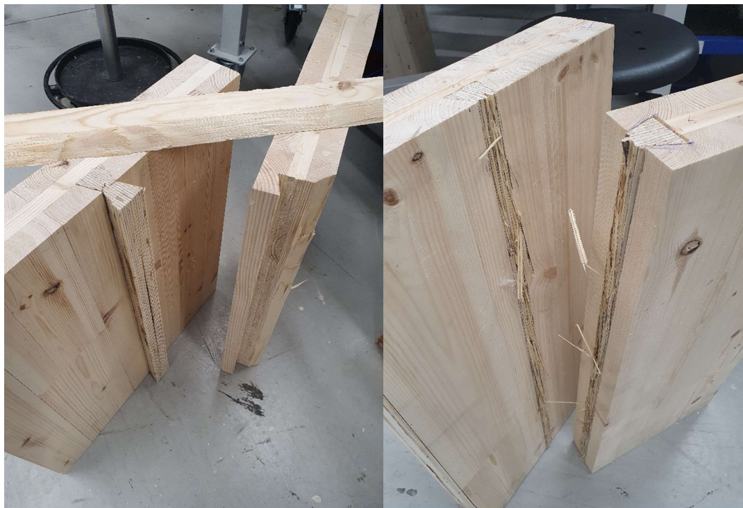
Kuva 30. ja 31. Ensimmäiset liituskappalet murtuivat sen ohuimmasta kohdasta (vasen kuva) ja kestävin kappale murtui keskeltä kiilapalaa. (oikea kuva)
