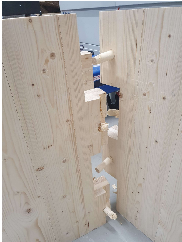
Kuva 32. Puutapit leikkoutuivat poikki mutta CLT-levy säilyi melko ehjänä.
