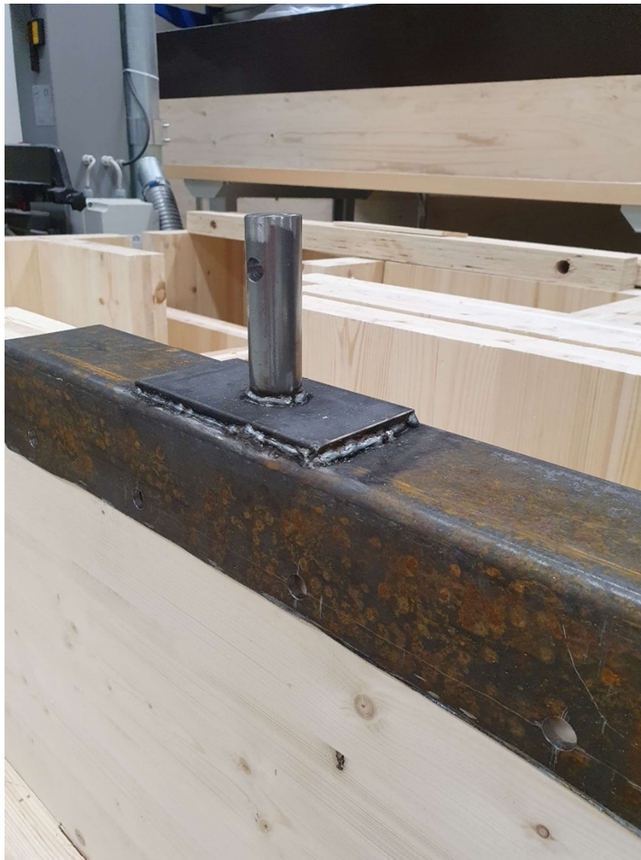
Kuva 27. Adapteri CLT-levyn päällä. Pyörötanko tulee kiinni puristimeen pultin avulla.
