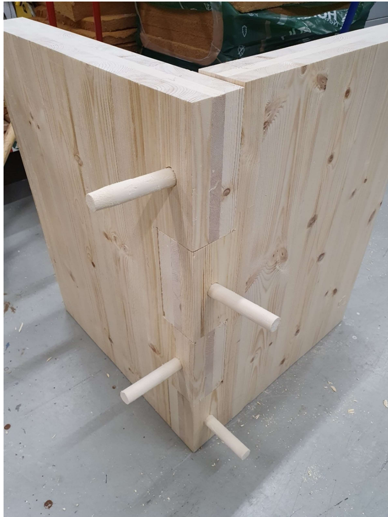
Kuva 25. Nurkkaliitos hammastustekniikalla. Puutapit lujittavat liitoksen.
