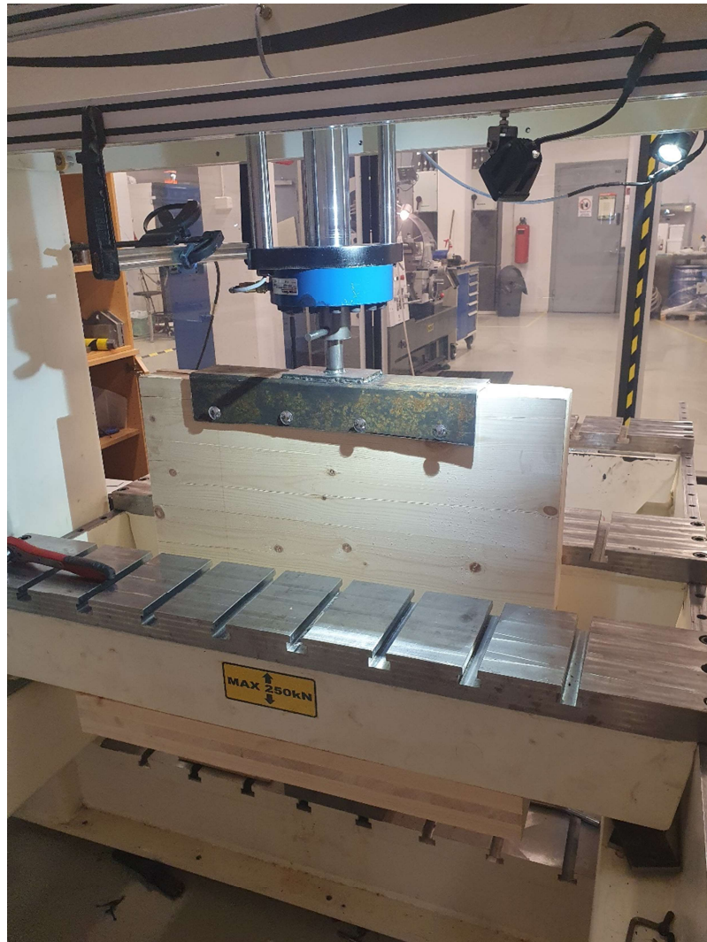
Kuva 28. CLT-levy puristimessa testaamista vaille valmiina
