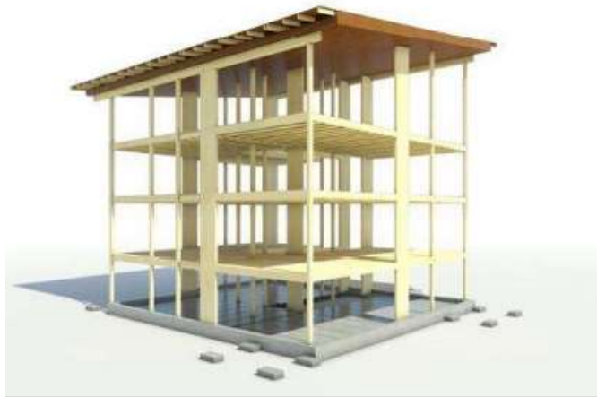
Kuva 3. Pilari- palkki järjestelmä [19].
