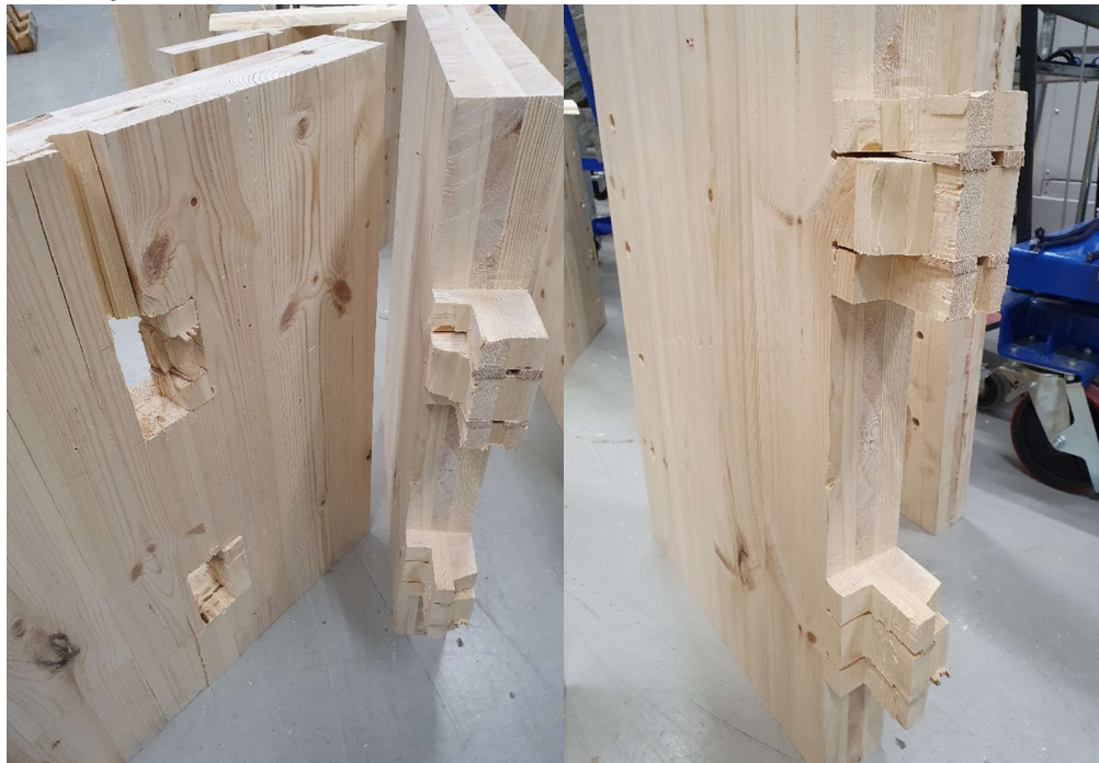
Kuva 29. Urosponnit murtuivat poikkisyyn olevien lamelleiden kohdalta.
