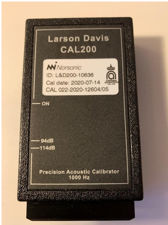
Kuva 15. Larson Davis äänimittarin kalibrointilaite
