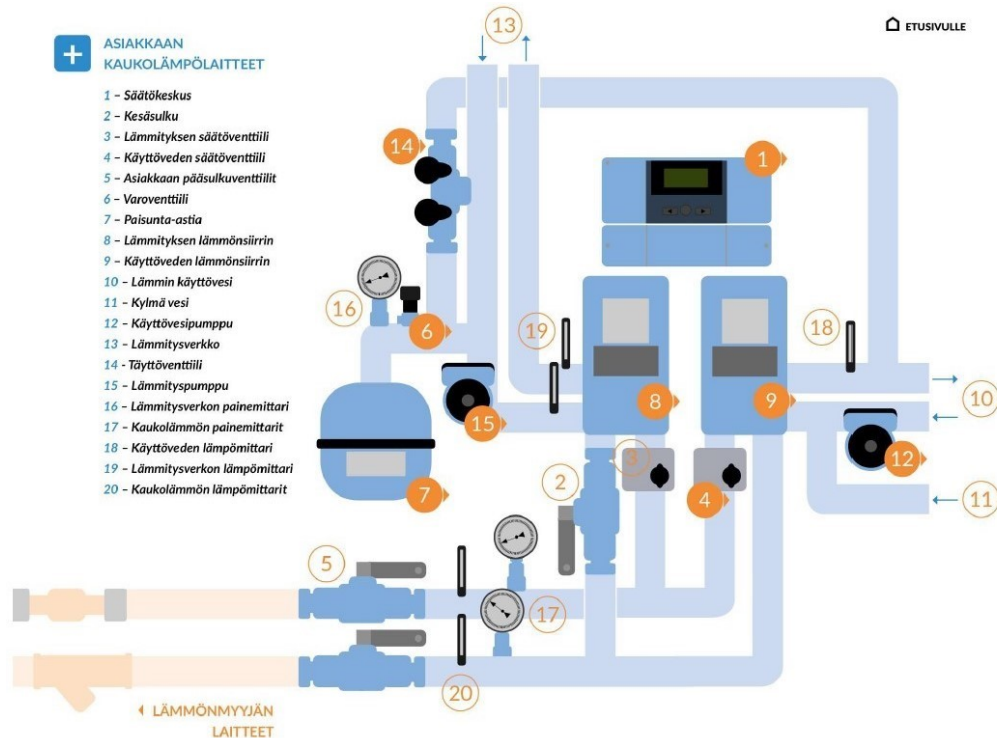
Kuva 2 Asiakkaan kaukolämpölaitteet lämmönjakokeskuksessa (Kaukolämmön ABC, 2020)
