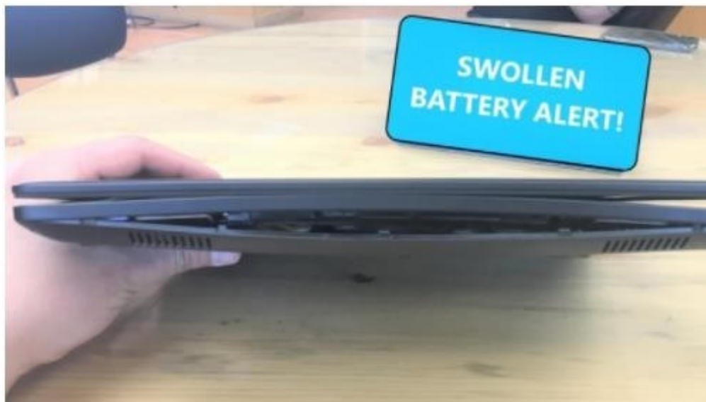
Kuva 16: Turvonnut kannettavan akku repinyt muoviosat irti toisistaan (Columbia forest products, 2021)
