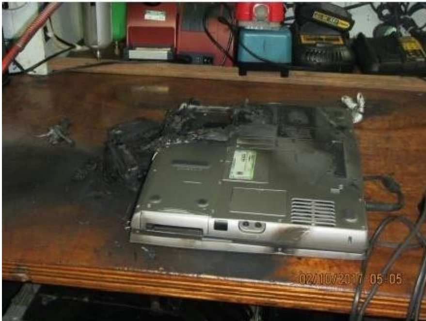
Kuva 17: Palamaan syttyneen akun aikaansaama tuho (IMCA, 2017)
