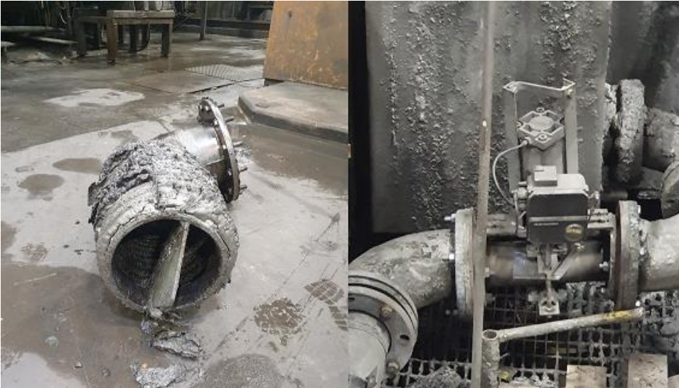
KUVA 3. Kuvassa vasemmalla vanha peräventtiili ja oikealla uusi letkuventtiili
