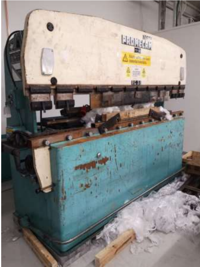
KUVA 10. Terä asennettuna särmäyspuristimeen leikkauksoikeita varten
