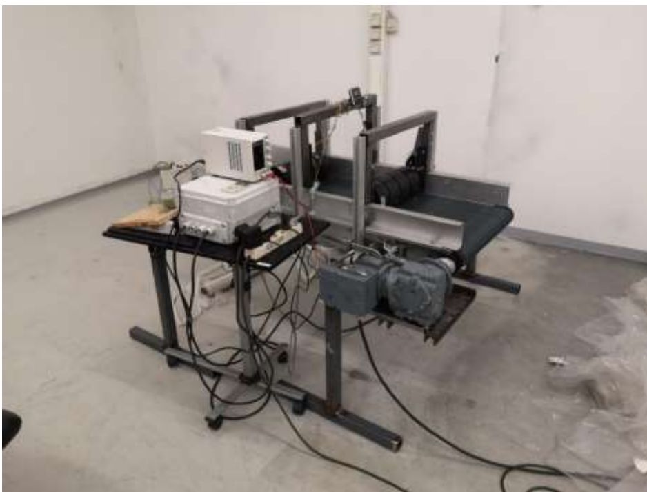
KUVA 5. Esikirstysrullien proof-of-consept laitteiston ensimmäinen versio
