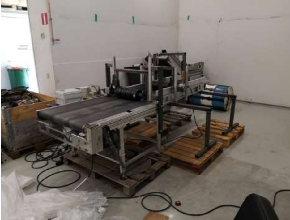
KUVA 6. Esikiristysrullien proof-of-consept-laitteiston toinen versio
