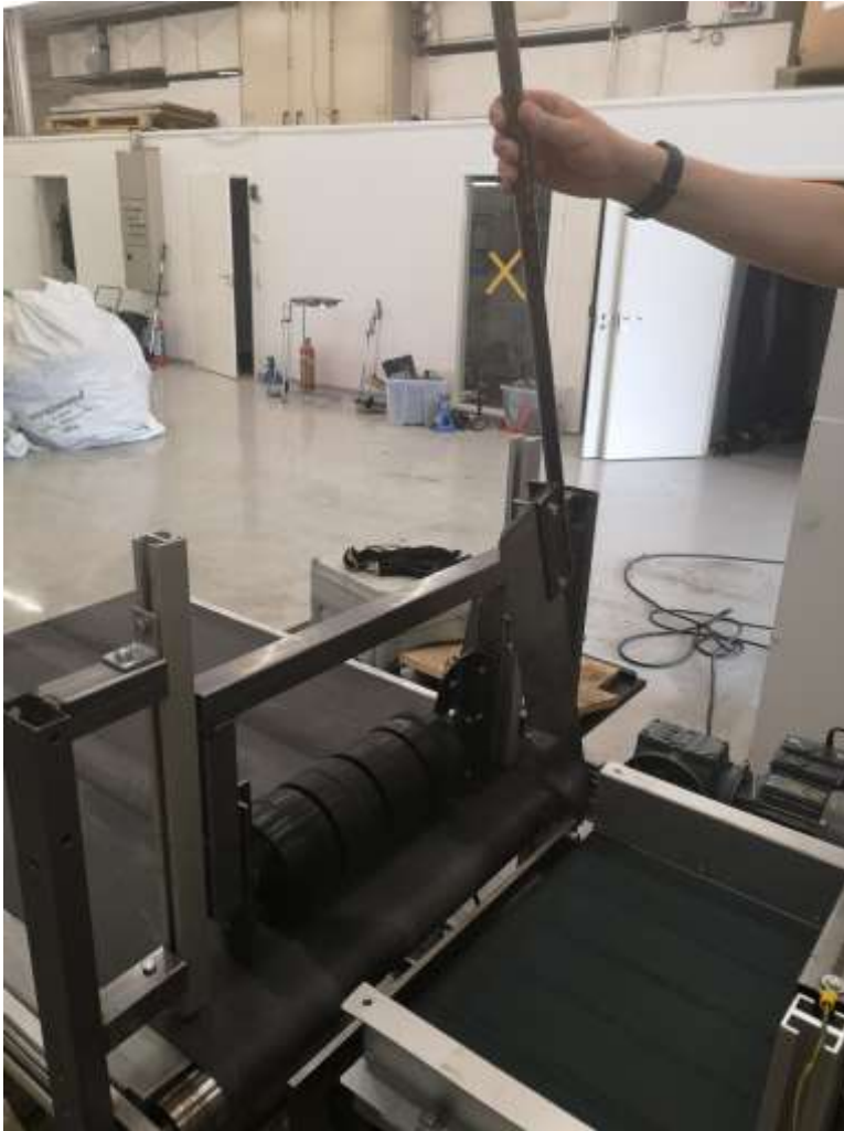
KUVA 9. Terällä toteutettu leikkauslaitteisto
