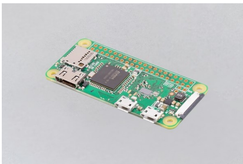
Kuva 8. Raspberry Pi Zero W (raspberrypi.org)
