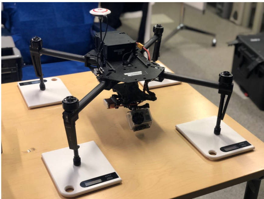
Kuva 16. Kulmapainojen punnitus kamera yläasennossa
