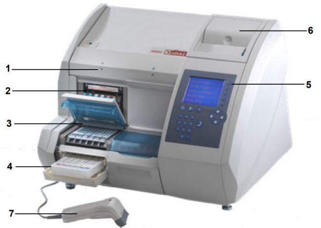
Kuva 3. MiniVIDAS-laitteisto. Näyteliuskat asetetaan kohtaan 3 ja pipetinkärjet kohtaan 2. [6.]
