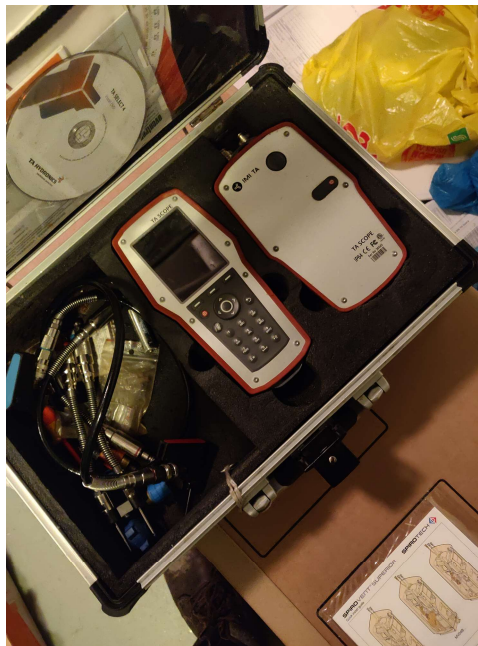
Kuva 15. IMI TA SCOPE, paine-erojen ja virtausten mittalaite.
